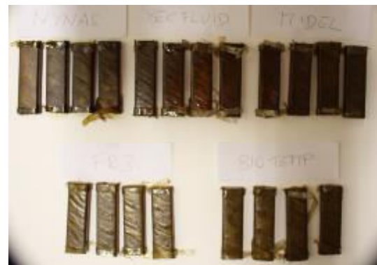
Kupferleiter lackiert/Epoxy beschichtet mit Papier
