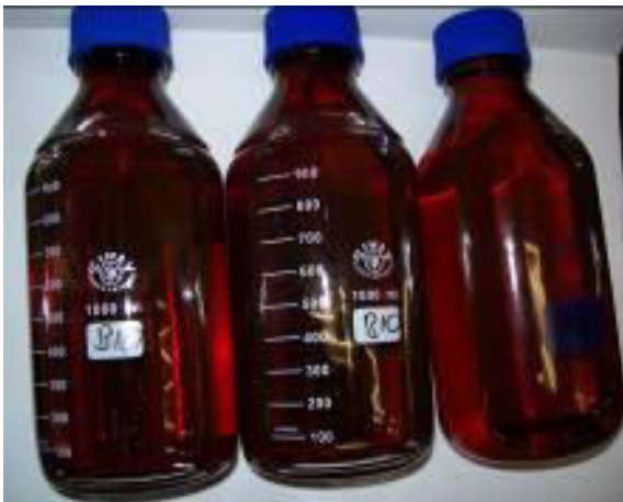
Abbildung 77: Biotemp Aluminium/Prepreg (Rohzustand)/Blindprobe 140°C
