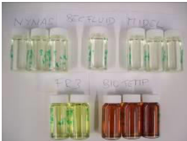
Abbildung 89: Alle Ölproben Gummisack/Radiatorlack. Reihenfolge: Blindprobe-Gummisack-Radiatorlack
