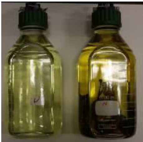
Abbildung 64: Nynas ohne/mit Proben 120°C
