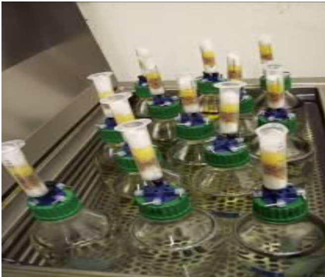
Abbildung 25: Versuchsaufbau (offenes Altern – Spritzenaufsatz mit 1l Duranflaschen)
