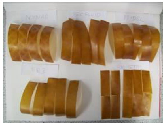
Abbildung 47: Prepreg (Rohzustand) 140°C
