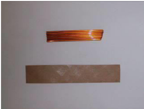
Abbildung 48: Cu mit Epoxid/Prepreg (ausgehärtet) unbehandelt
