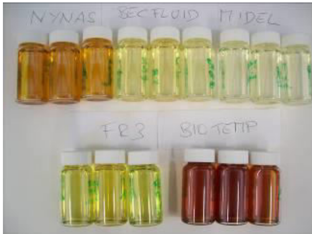
Abbildung 84: Ölproben Cu mit Epoxidharz/Prepreg (ausgehärtet) – Reihenfolge: Blindprobe-Cu mit Epoxidharz-Prepreg (ausgehärtet)
