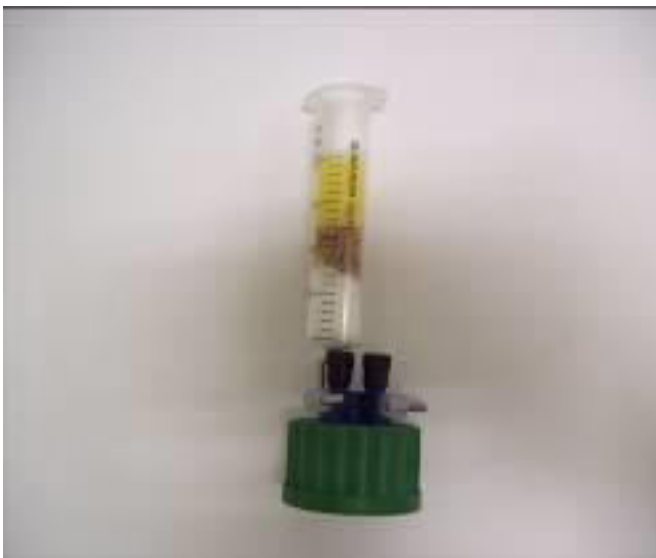
Abbildung 26: Verschluss für offenes Altern (Spritzenaufsatz mit Glaswolle und Trockenmittel)
