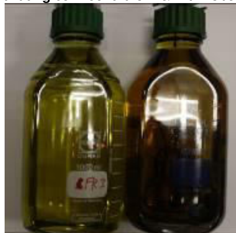
Abbildung 67: FR3 ohne/mit Proben 120°C
