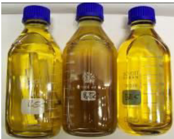
Abbildung 74: Becfluid Aluminium/Prepreg (Rohzustand)/Blindprobe 140°C
