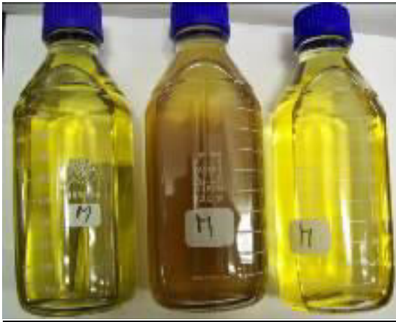
Abbildung 75: Midel Aluminium/Prepreg (Rohzustand)/Blindprobe 140°C
