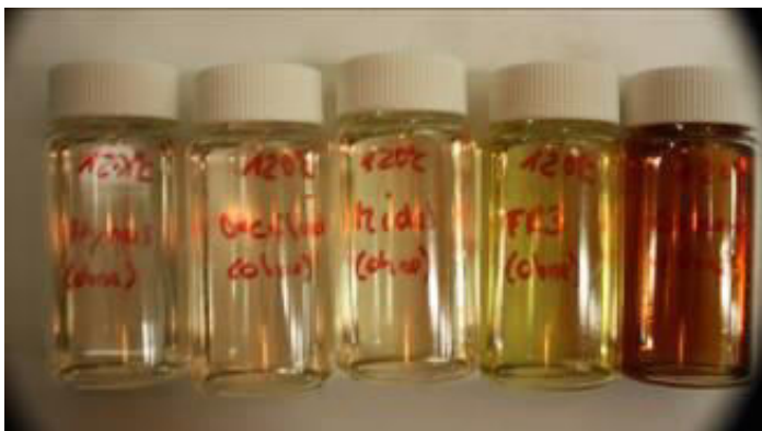
Abbildung 58: Farbvergleich Ungealterte Ölproben
