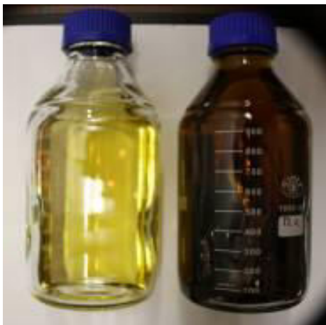
Abbildung 61: Midel ohne/mit Proben 140°C
