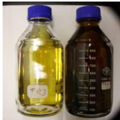
Abbildung 62: FR3 ohne/mit Proben 140°C
