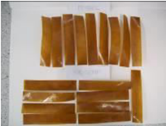
Abbildung 51: Prepreg (ausgehärtet) Midel/Biotemp
