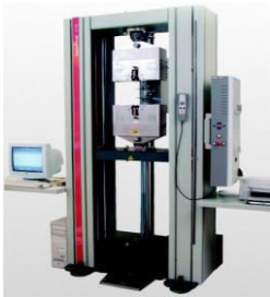
Abbildung 9: Gerät für Zug- und Biegeprüfungen 17
