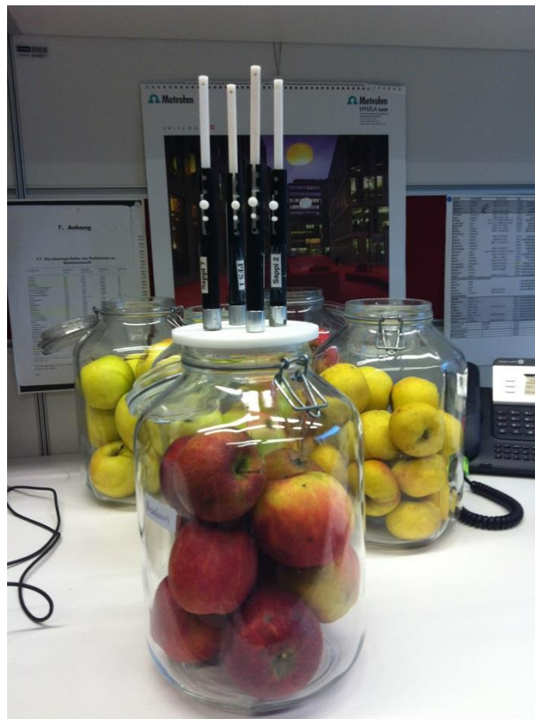
Abbildung 15: Vier Portable Field Sampler SPME Fasern wurden eine Stunde lang exponiert in einem mit Äpfeln gefüllten Glas
