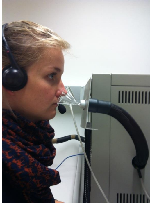
Abbildung 7: Mit dem sogenannten Sniffing Port schnüffelt eine sensorisch geschulte (oder auch ungeschulte) Person einen Teil des Gasstromes ab und detektiert so die aromaaktiven Verbindungen
