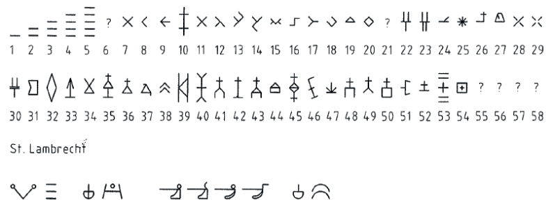
Abb. 2.30: Oben: Abbundzeichen am Dachtragwerk der Liebfrauenmuenster – Kirche in Ingolstadt; Unten: Spät-mittelalterliche Abbundzeichen (vgl. Caston (1998 S. 528))
