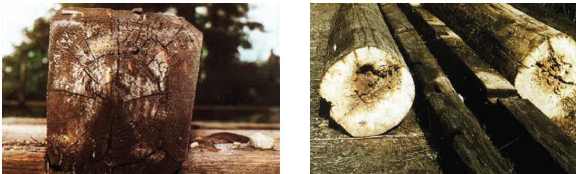
Abb. 3.10: Links: Feines Myzel und Ringschäle nach Blättlingsbefall; Rechts: Innenfäule durch Blättlingsbefall (ERLER (2004 S. 67 – 68))
