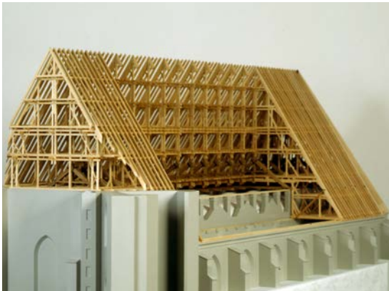
Abb. 2.41: Dachtragwerk der Liebfrauenmünster – Kirche in Ingolstadt/Deutschland im Maßstab 1:50. Die Konstruktion stammt aus dem Jahre 1491/1492 und überspannt eine Gesamtbreite von 31 Metern und weist eine Höhe von 25 Metern auf (Foto: BÜRGERSERVICE-PORTAL STADT INGOLSTADT)
