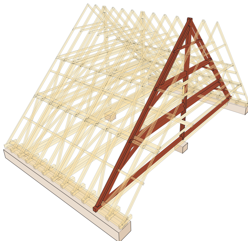
Abb. 2.19: Lage und Aussehen eines Vollgespärres im Dachtragwerk der Alten Universität Graz
