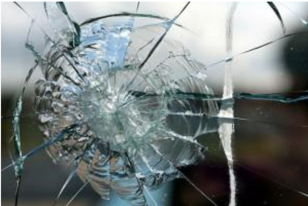
Abbildung 2.6 Bruchbild von Floatglas [22]
