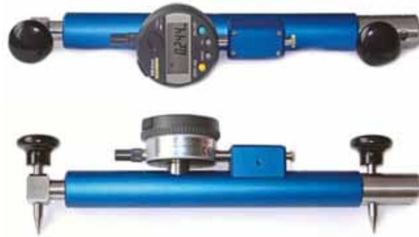
Abbildung 4.60: Deformeter in Drauf- und Ansicht mit montierter digitaler Messuhr 154
