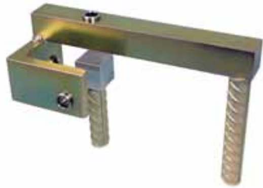
Abbildung 4.57: Einfaches Jointmeter mit Bohrungen für die Aufnahme für drei LVDT's zur 3D-Vermessung 150
