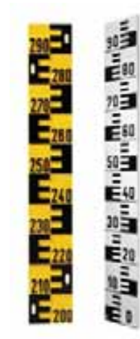
Abbildung 4.3: Lattenpegel mit 2 [cm]- und 1 [cm]-Teilung 84
