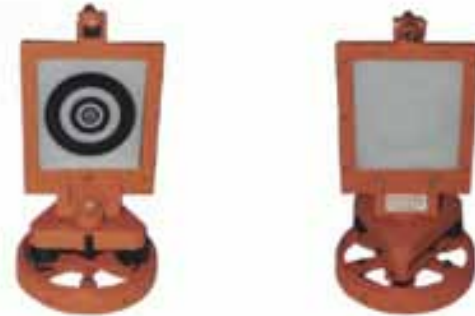
Abbildung 4.43: Zielmarken für optisches Alignment 134
