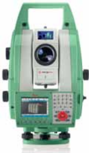
Abbildung 4.52: Multistation inklusive Laser-scannereinheit 145
