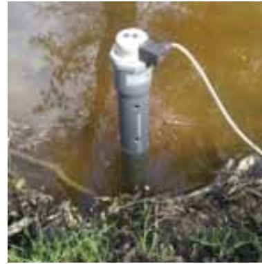
Abbildung 4.11: Ultraschallsensor auf Schallschutz- und Beruhigungsrohr 92
