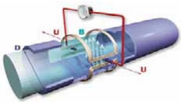
Abbildung 4.65: Durchflussmessung, magnetisch-induktiv (Systemskizze) 159
