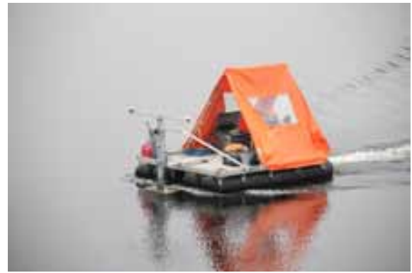
Abbildung 4.82: Sedimentniveaubestimmung mittels Fächer-Echolot und GPS-Positionierung 176
