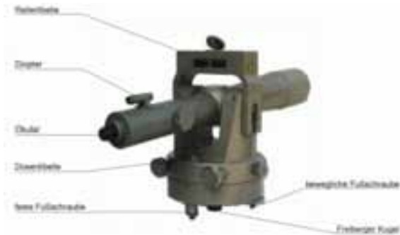
Abbildung 4.42: Ablesegerät für optisches Alignment (Kollimator) 133
