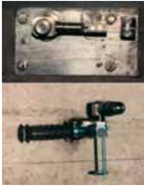
Abbildung 4.40: Draht-Alignment mit Fixpunkt (oben) und Ableseeinrichtung (unten) 131
