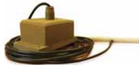
Abbildung 4.74: Thermoelement in Gehäuse für den Einbau in Beton 168
