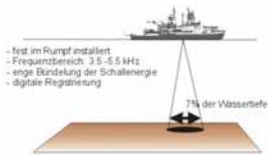
Abbildung 4.81: Sedimentniveaubestimmung mittels Echolot von einem Boot aus (Systemskizze) 175
