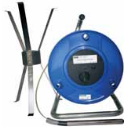
Abbildung 4.35: Setzpegelsonde an Kabeltrommel und Magnet 125
