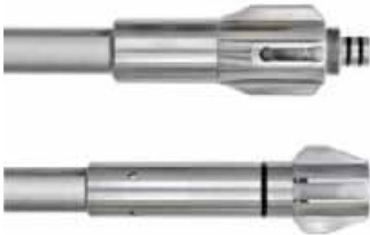
Abbildung 4.32: Sondenkopf und -ende eines Bohrlochmikrometers 122
