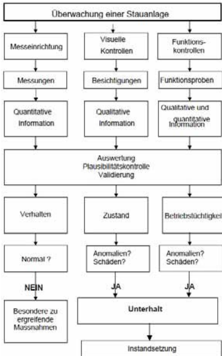
Abbildung 4.1: Gesamtkonzept der Organisation der Überwachung und des Unterhalts 81
