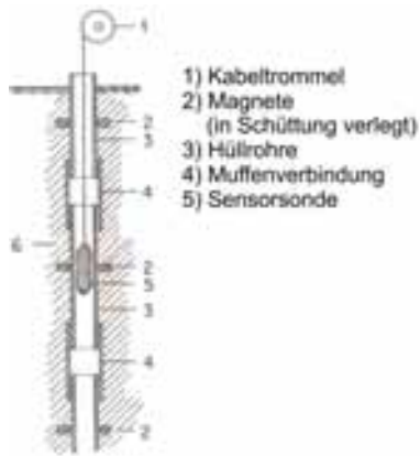
Abbildung 4.34: Setzpegel (Systemskizze) 124
