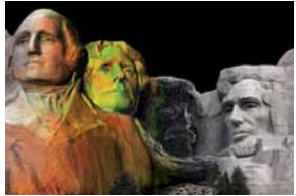
Abbildung 4.51: terrestrischer Laserscan am Beispiel des Mount Rushmore (von der Punktwolke bis zum Modell) 144
