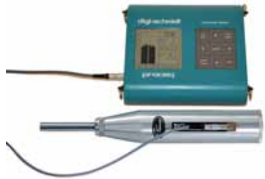
Abbildung 4.84: Schmidt-Hammer mit digitaler Auswertung und Aufzeichnung 178
