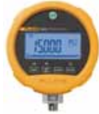
Abbildung 4.6: Präzisionsmanometer in handlicher Ausführung 87
