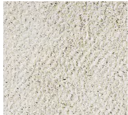
Abb. 184: Oberfläche gespitzt, gestockt, gebeilt und überschliffen
