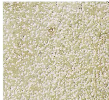
Abb. 185: Oberfläche gestockt, gebürstet und gewachst
