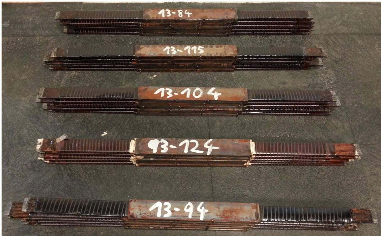
Abbildung 10.4: Prüfstäbe nach dem ersten Thermozyklus
