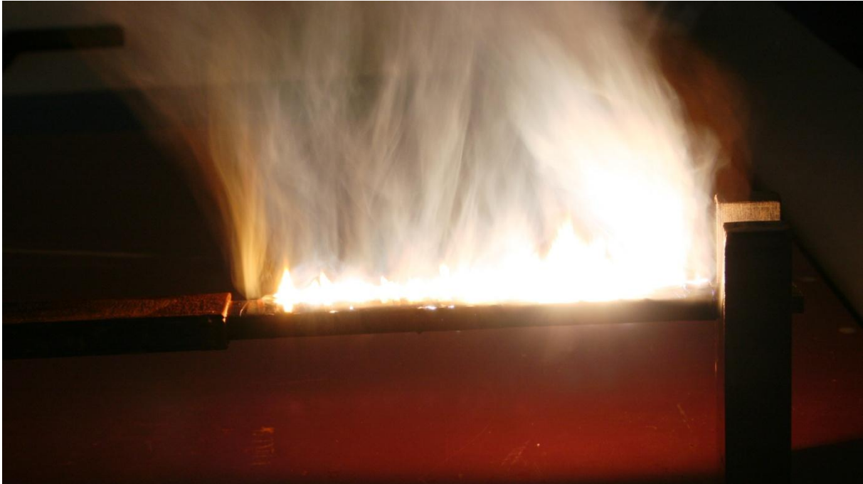
Abbildung 10.6: Zerstörung des Wickelkopfes
