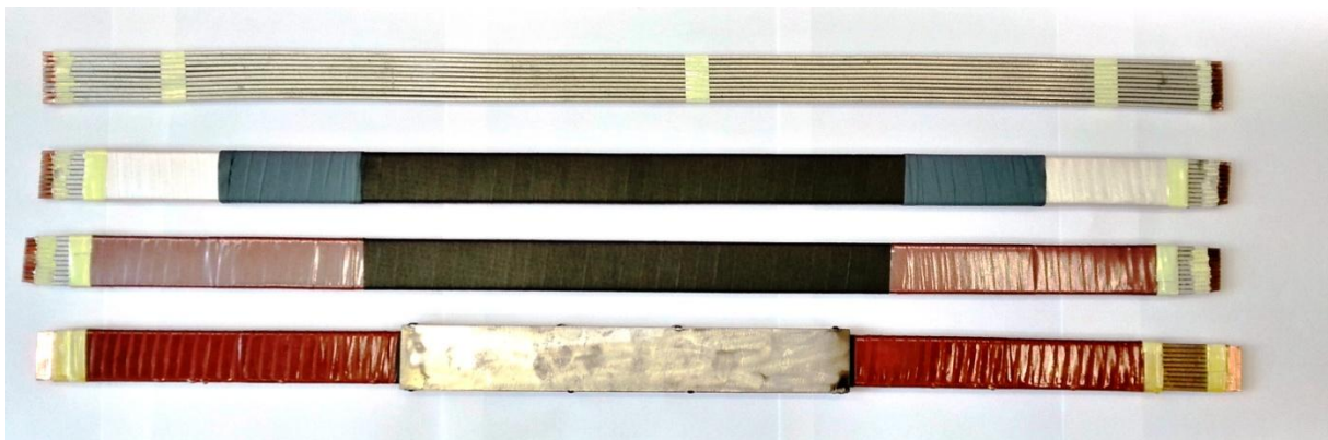
Abbildung 3.4: Prüflingsaufbau vom Teilleiterstab bis zum fertigen Testobjekt
