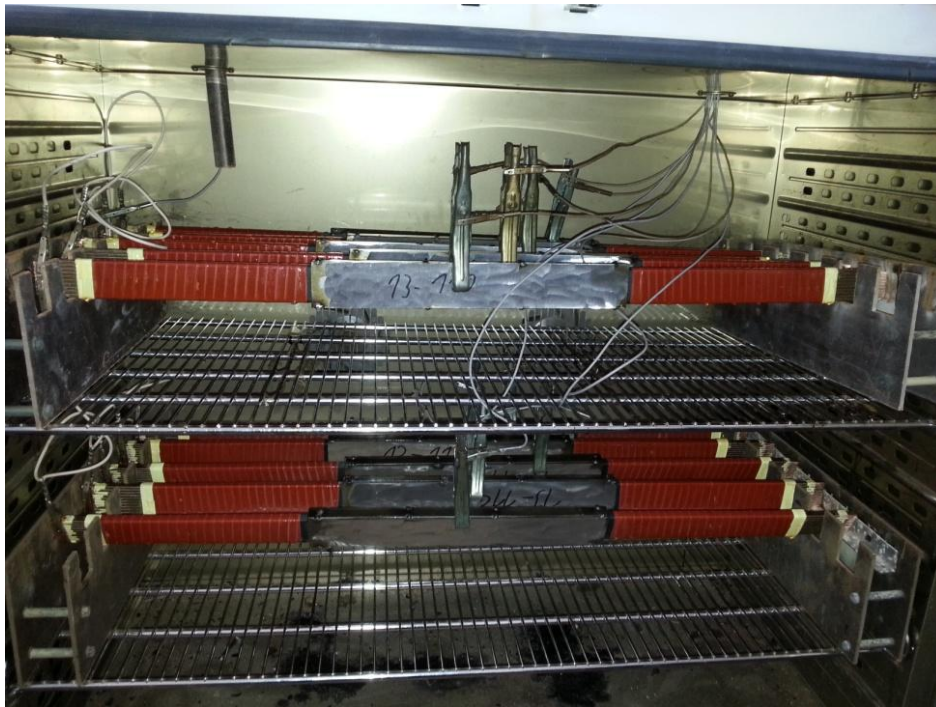
Abbildung 5.7: Verlustfaktormessung unter Temperatur
