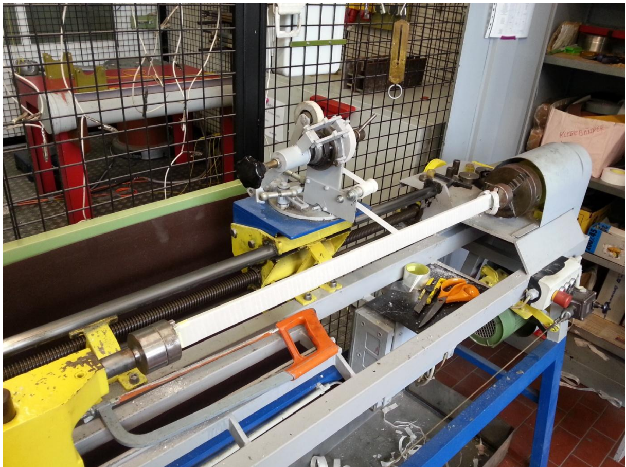
Abbildung 10.2: Wickeln der Hauptisolation
