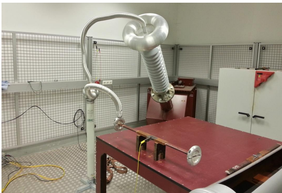
Abbildung 5.23: Messaufbau zur Teilentladungsmessung
