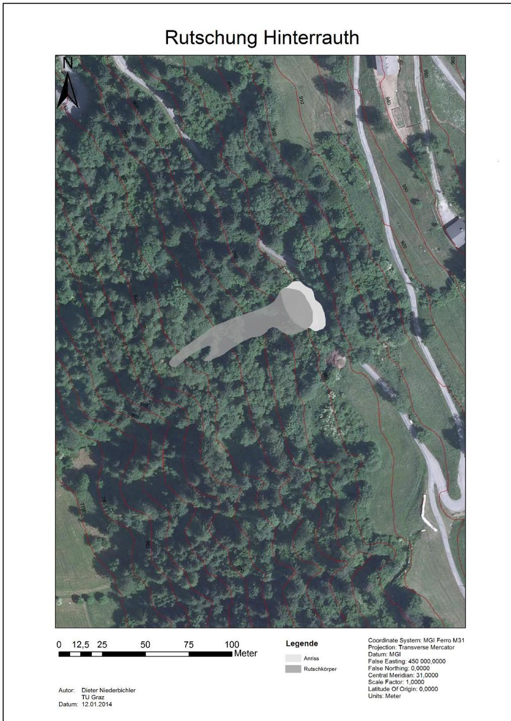
**Abbildung 4-7: Lage und Ausmaß der Rutschung Hinterrauth**
