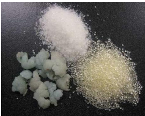
Abb. 2-11: Verschiedene Arten von Aquabeads vor dem Sättigen mit Wasser (Lo et al., 2008)
