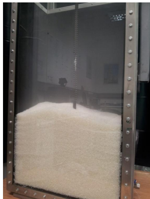
Abb. 4-41: Bodenkörper wird um den Stab eingefüllt
