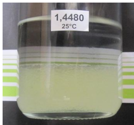
Abb. 3-14: Gesättigtes Silica Gel nach Iskander (2010) und Porenfluid mit Brechungsindex nach Zhao (2007)
