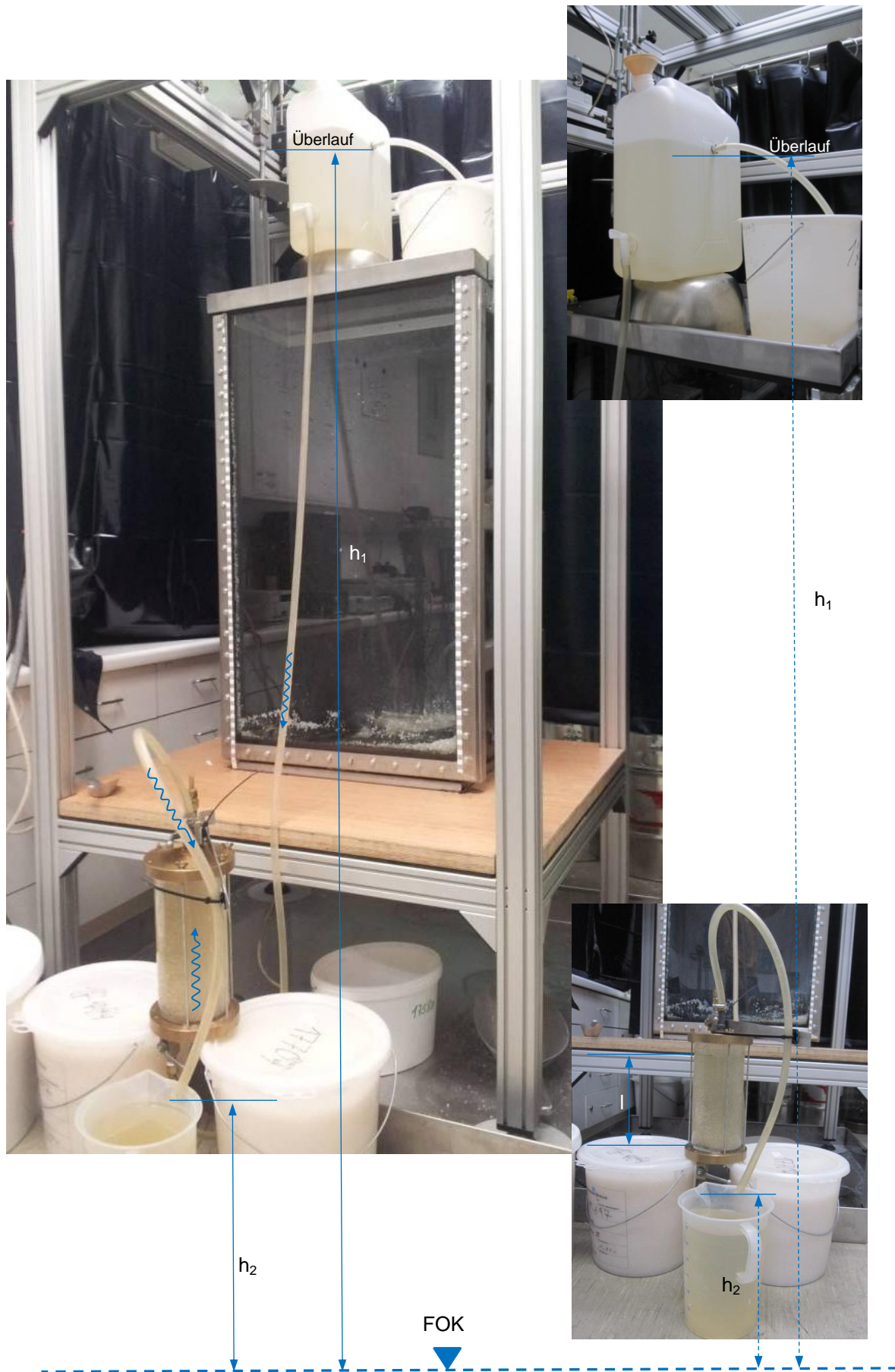
Abb. 3-23: Entwickelter Versuchsaufbau zur Bestimmung der Durchlässigkeit des Silica Gels
