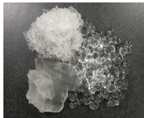
Abb. 2-12: Verschiedene Arten von Aquabeads nach dem Sättigen mit Wasser (Lo et al., 2008)
