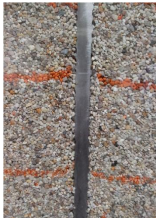
Abb. 2-3: Beobachtung von Verschiebungen an einer Grenzfläche durch farbige Markierungen
