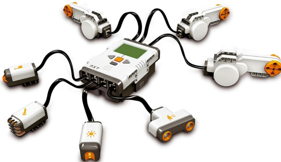
Abbildung 2.2: NXT-Baustein mit angeschlossenen Motoren und verschiedenen Sensoren 7
