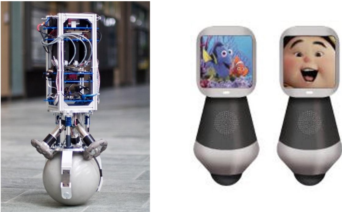
Abbildung 1.2: Links: Ballbot Rezero von der ETH Zürich 2 ; Rechts: Rezero mit Infoscreen für die Firma Disney (Konzept) 3
