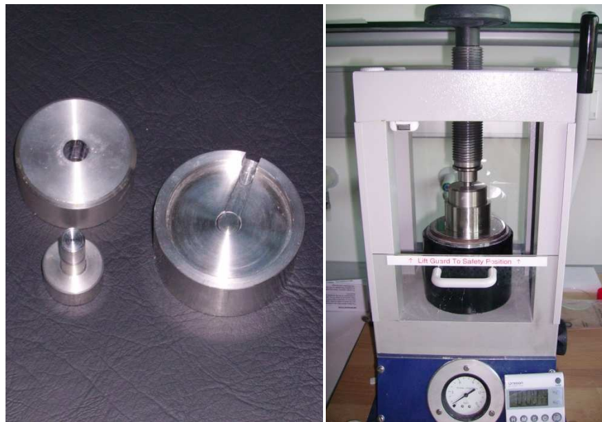
Abbildung 27: Teile des Presswerkzeugs für die CV-Elektroden (links) und Hydraulikpresse (rechts).
