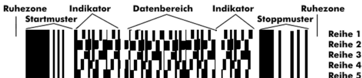
Abbildung 2-4 PDF417 Code Aufbau (PDF417 bar code, 2013)
