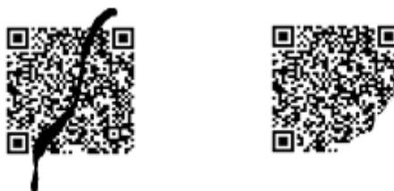
**Abbildung 2-7 QR-Code Fehlerkorrektur (Denso Wave, 2013)**
