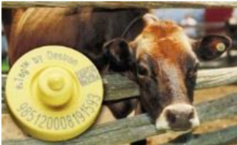
Abbildung 3-3 RFID-Tag (mit zusätzlich optischem Code) bei einem Rind (Bob Brewin, 2005)
