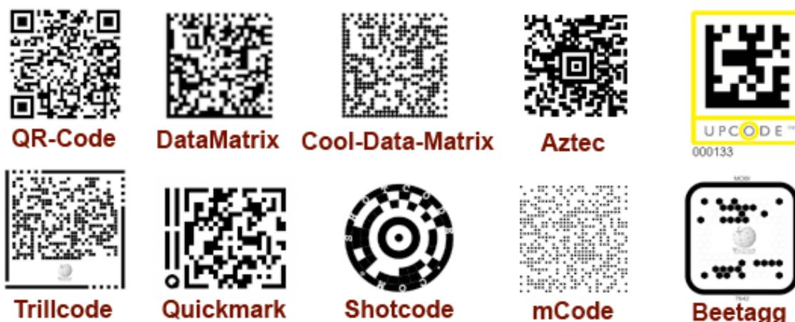
Abbildung 2-1 Einige zweidimensionale Codes im Überblick (Mobile Tagging, 2007)
