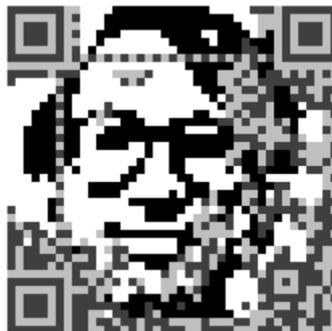
**Abbildung 2-20** QArt QR-Code mit Fehlerkorrektur (QArt Codes, 2012)
