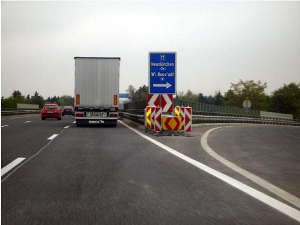
Abbildung 10: Stationierungspunkt als Anpralldämpfer einer Ausfahrt [33]
