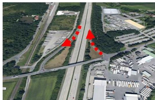
Abbildung 4: Schematische Darstellung einer Halbanschlussstelle [20]
