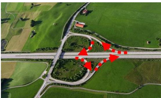
Abbildung 3: Schematische Darstellung einer Anschlussstelle [36]
