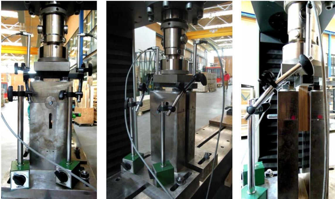
Abb. 4.3: Prüfkongfiguration – Durchführung der Druckprüfungen an Probekörpern mit verringertem Randabstand
