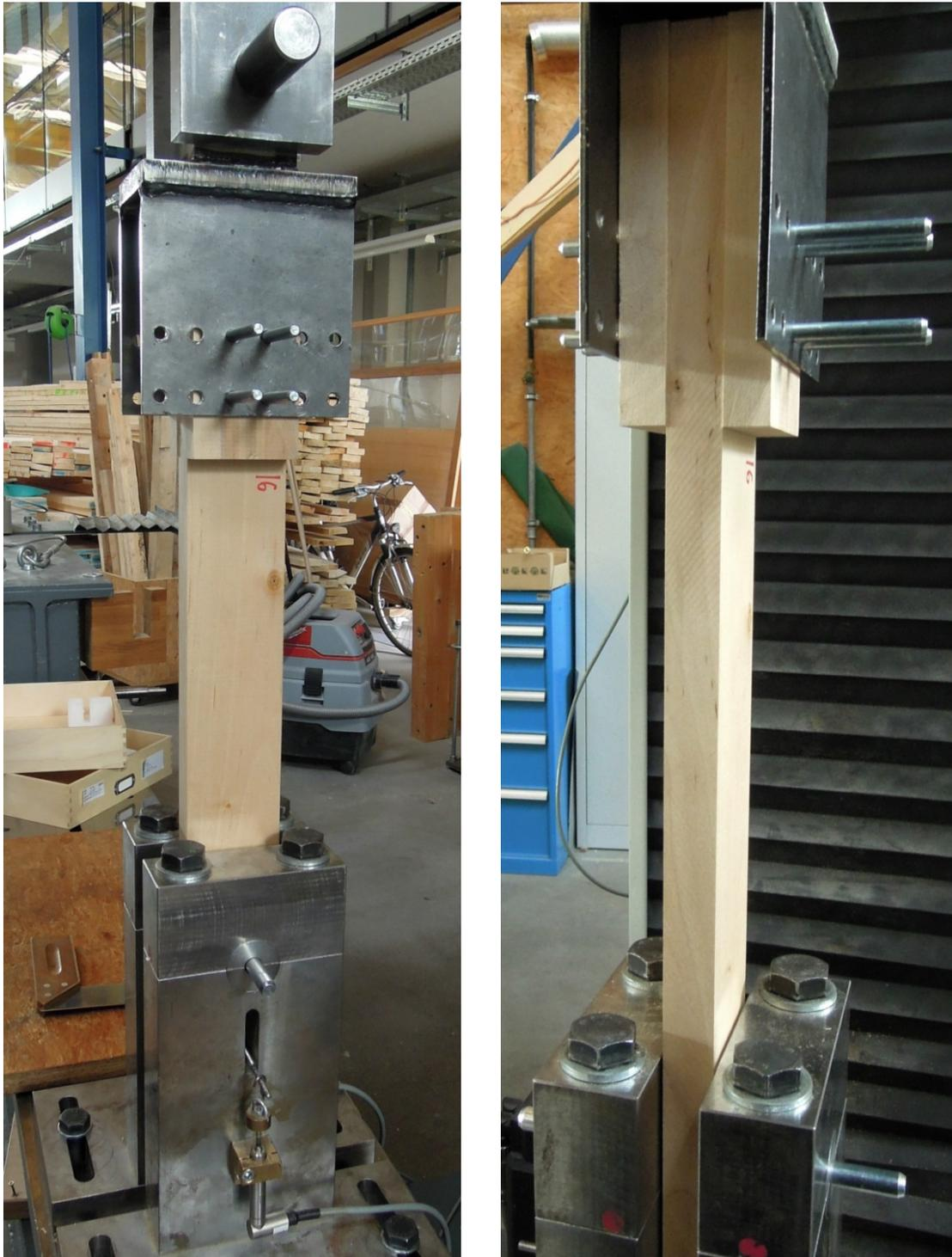
Abb. 3.14: Prüfkongfiguration – Durchführung der Zugprüfungen
