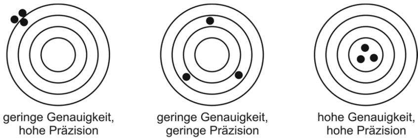
Bild 3.2 Unterschied Genauigkeit – Präzision<sup>4</sup>
