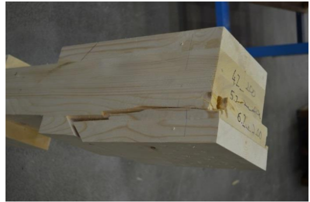
Abbildung 126: Schubversagen (Blockscheren)
