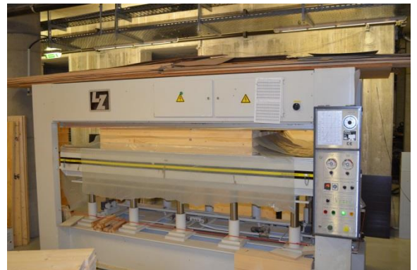
Abbildung 13: Probekörperherstellung; links: Gerät zum Auftrag des Klebers; rechts: hydraulische Presse
