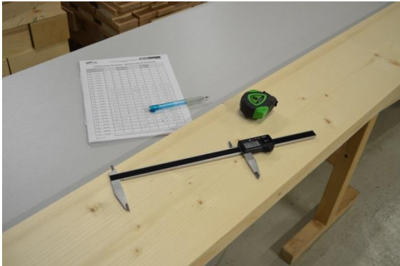
Abbildung 16: Messungen an Probekörpern; links: Schiebelehre und Maßband; rechts: Waage
