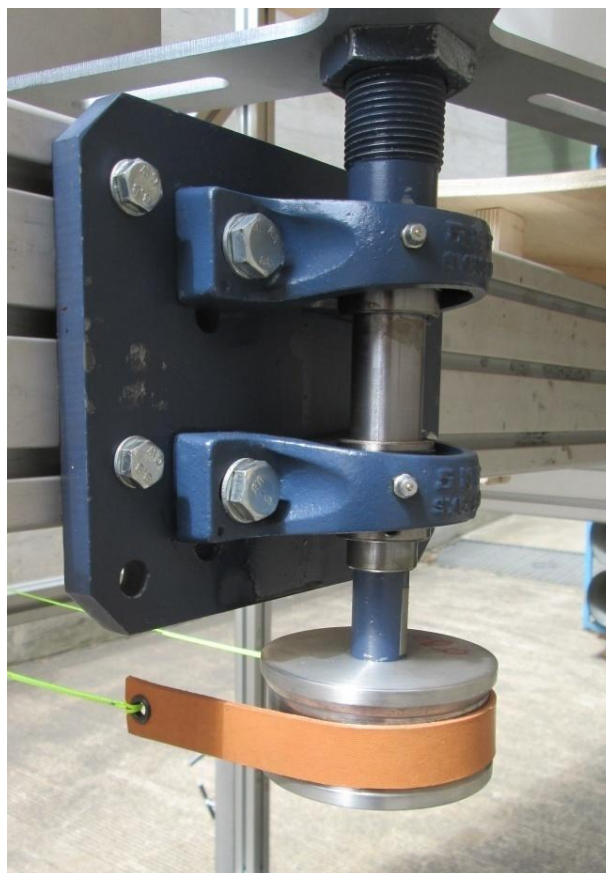
Abbildung 6-8: Gewindespindel und Hangwaagen (links), Lederriemen um Riemenscheibe (rechts)
