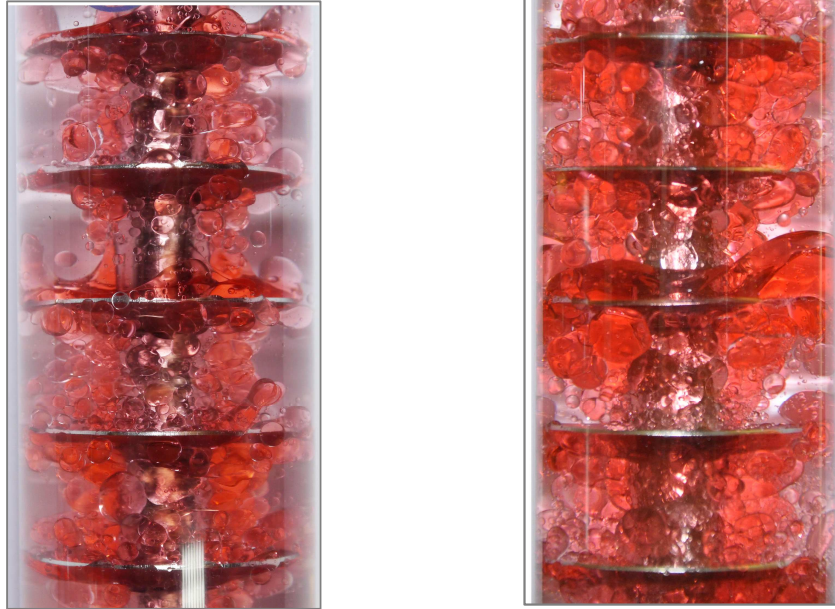
Abbildung 4-36 - Ausbildung der dispersen Phase bei 800 [1/min]; links: Volumenstrom 4 [l/h]; rechts: Volumenstrom 6 [l/h]
