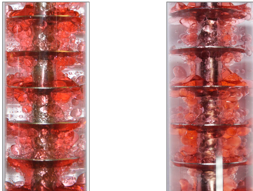
Abbildung 4-37 - Ausbildung der dispersen Phase bei 4[l/h] organischer und kontinuierlicher Phase und links: 650 [1/min]; rechts: 700 [1/min]
