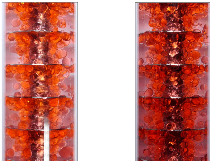
Abbildung 4-35 – Ausbildung der dispersen Phase bei 6[l/h] organischer und kontinuierlicher Phase und links: 650 [1/min]; rechts: 700 [1/min]
