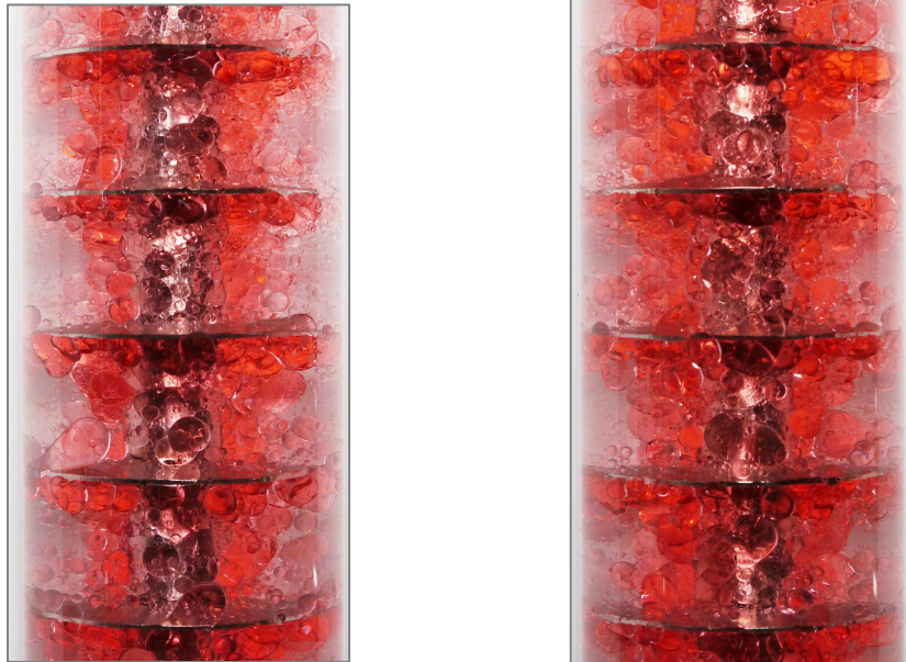
Abbildung 4-38 - Ausbildung der dispersen Phase bei 800 [1/min]; links: Volumenstrom 4 [l/h]; rechts: Volumenstrom 5 [l/h]
