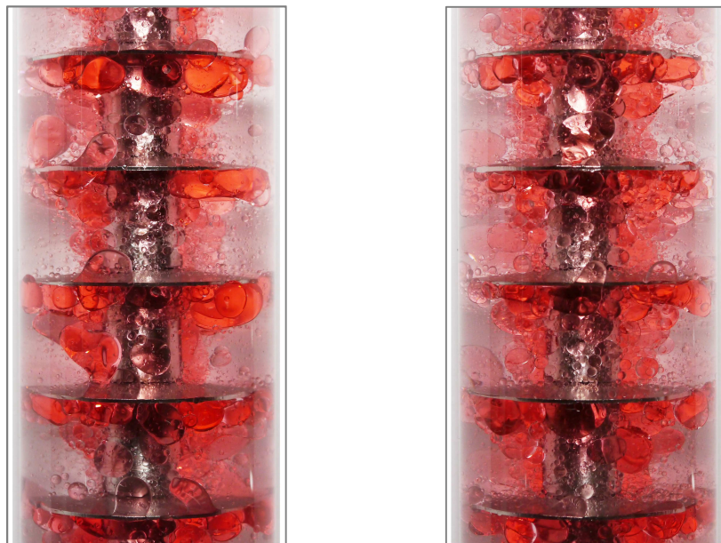
Abbildung 4-39 - Ausbildung der dispersen Phase bei 4 [l/h] organischer und kontinuierlicher Phase und links: 650 [1/min]; rechts: 700 [1/min]
