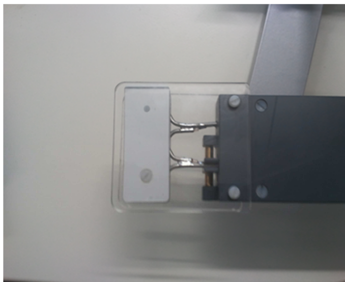
Abbildung 32: Double Loop Coil wie sie für die Transmissionsmessung eingesetzt wird. Die beiden Einzelpulen dieses Messkopfes sind über eine Distanzschraube so zu überlappen, dass sie mit einer maximalen Dämpfung von ungefähr 90dB gegeneinander entkoppelt sind.
