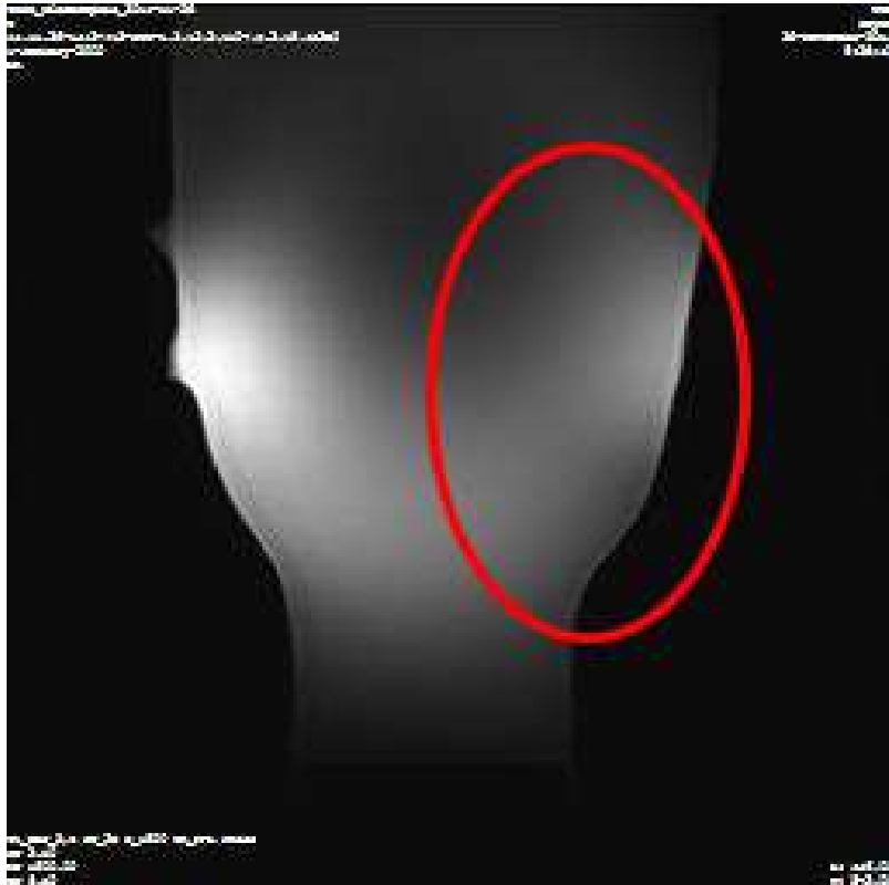
Abbildung 48: Sagittale Aufnahme des Kopfphantoms mit allen funktionierenden Kanälen. Im rot markierten Bereich können eindeutig Intensitätsunterschiede im Vergleich zur gegenüberliegenden Seite ausgemacht werden. Beide defekten Kanäle befinden sich auf der Seite der Markierung.
