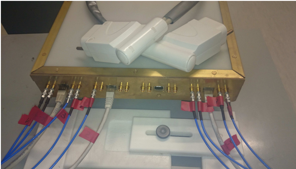
Abbildung 34: ComBoard zur Verbindung des Empfangskonstrukts mit dem MR-Tomographen. Cat7-Netzwerkkabel für die Verbindung der aktiven Entkopplungen, Steckverbinder der Firma Lemo zur Verbindung der Vorverstärker.
