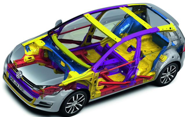
Abbildung 1: Sicherheitsstruktur des VW Golf VII aus Stahl, Stahl-Informationszentrum/Volkswagen [28]
