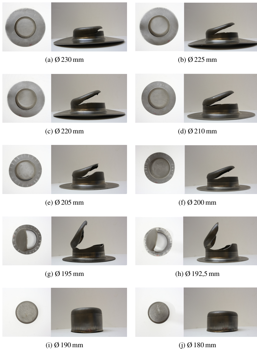
Abbildung 29: Ermittlung des Grenzziehverhältnisses
