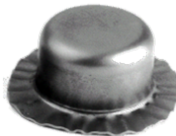
(b) Faltenbildung 1. Ordnung am Flansch
