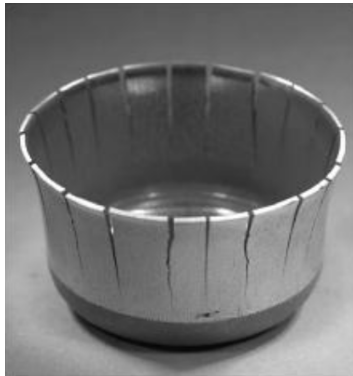
Abbildung 5: Tiefziehnäpfchen des TWIP-Stahls X-IP® 980 [17]
