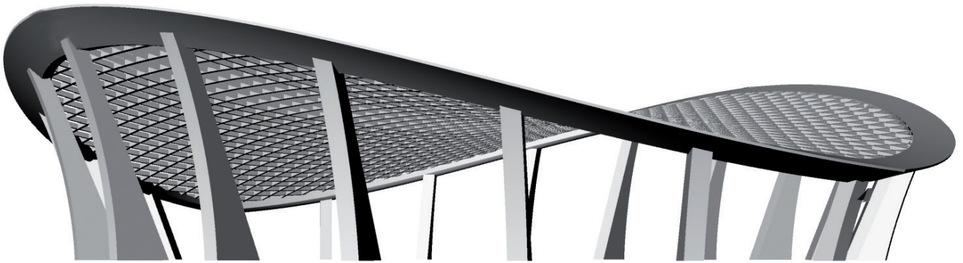
06_in Rhino modelliertes, doppeltgekrümmtes Tragwerk
