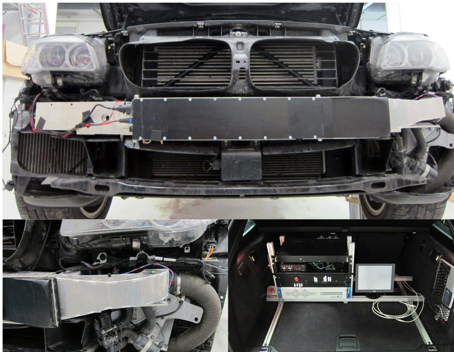
Abbildung 4.3: Integration des Ko-TAG-Sensors in den Versuchsträger - oben: Ko-TAG-Sensor, unten links: Luftkühlung, unten rechts: Messtechnik im Kofferraum
