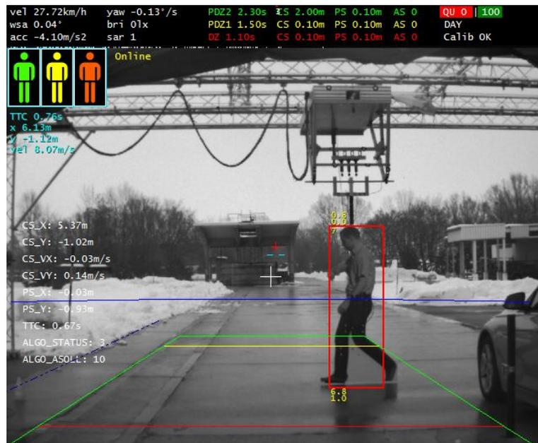
Abbildung 4.5: ADF-Überlagerung, Messfahrt am Fußgängerprüfstand mit Ko-TAG, Kamerabild des Fahrzeuges und Ko-TAG Overlay am linken Bildrand
