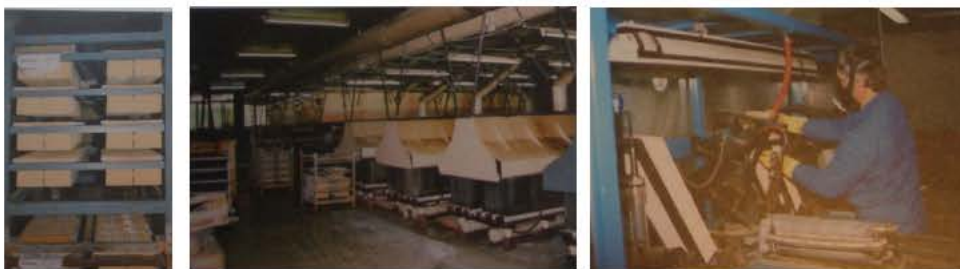
Abb.56-58: Trocknungslager, Trocknungsanlage, da Bleidämpfe gesundheitsschädlich sind mussten viele Arbeiten mit Atemwegsschutzmasken ausgeführt werden
