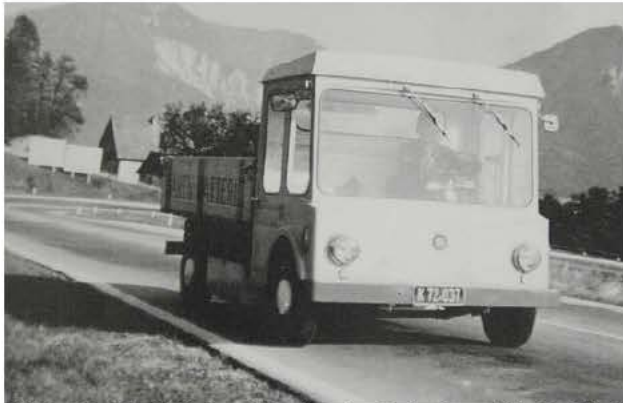
Abb.26: E-LKW des Werkes in Feistritz, Abb.27: "Eidechsen"-Abtransport Werkfahrzeug für Batterien
