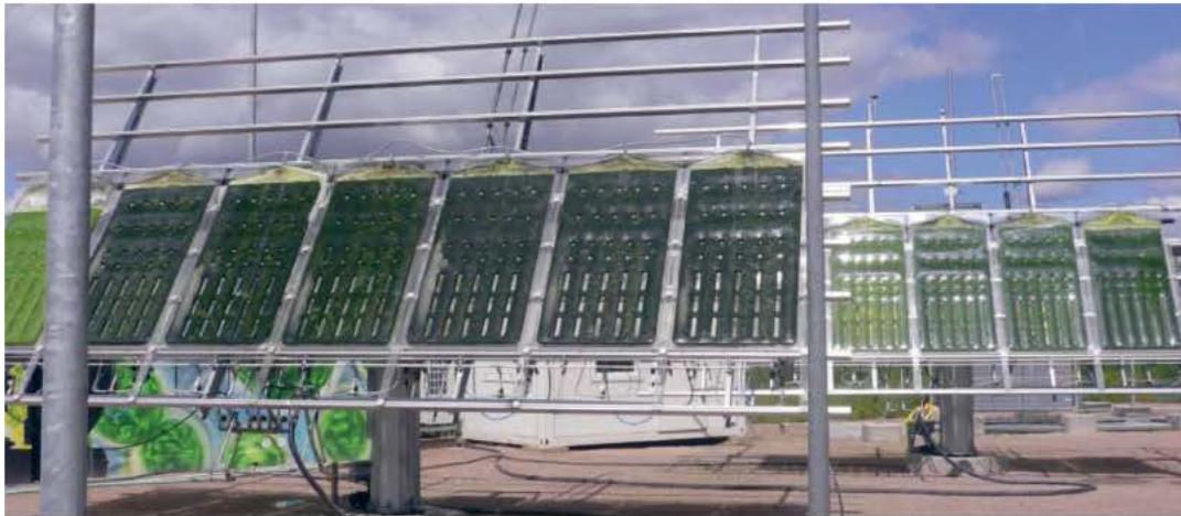
Projekt TERM: Sonnennachgeführte Photobioreaktoren der SSC GmbH
