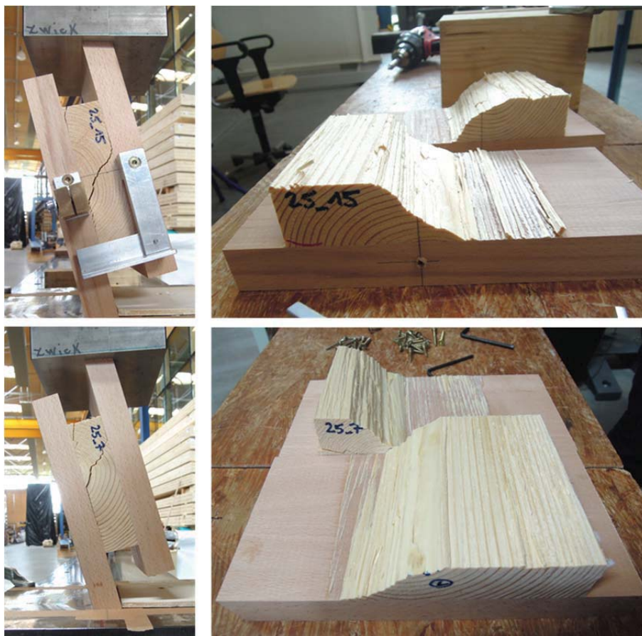
Abb. 3-20: Bruch mit Z-Verlauf, sägezahnförmig entlang von Jahrringen bei Kiefernprüfkörper
