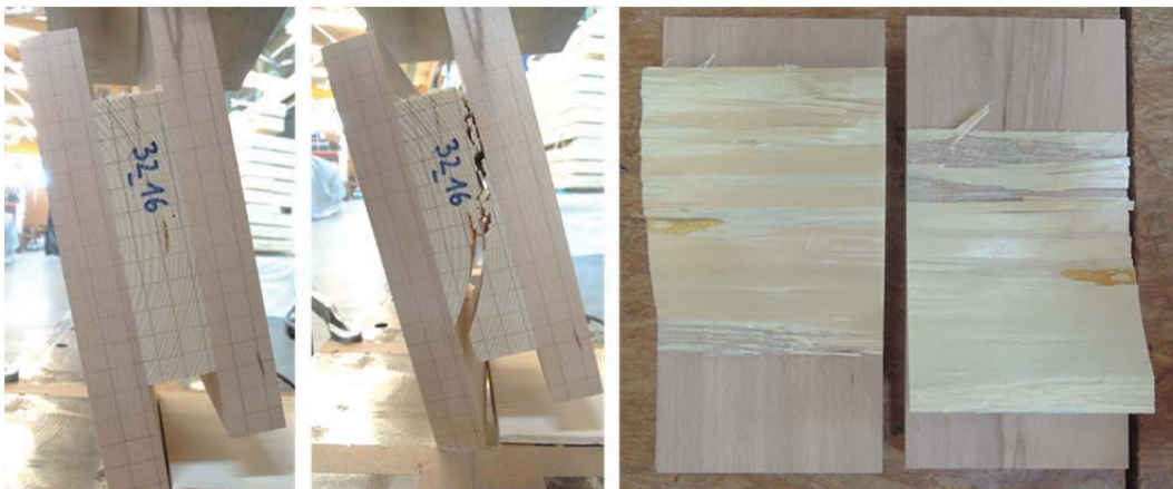
Abb. 3-24: Häufige Versagensform in Serie 3.2
