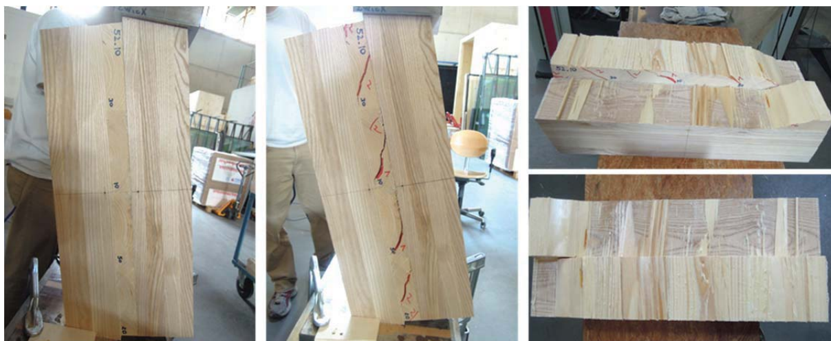
Abb. 3-32: Aufbau, Rissbildung und Versagen eines Prüfkörpers der Serie 5.2
