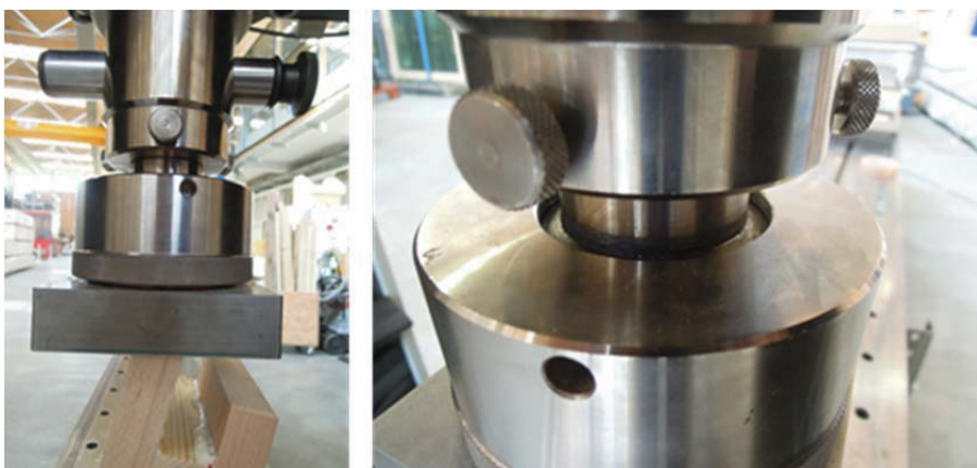
Abb. 2-10: Sphärisch gelagerte Platte zur Lastaufbringung
