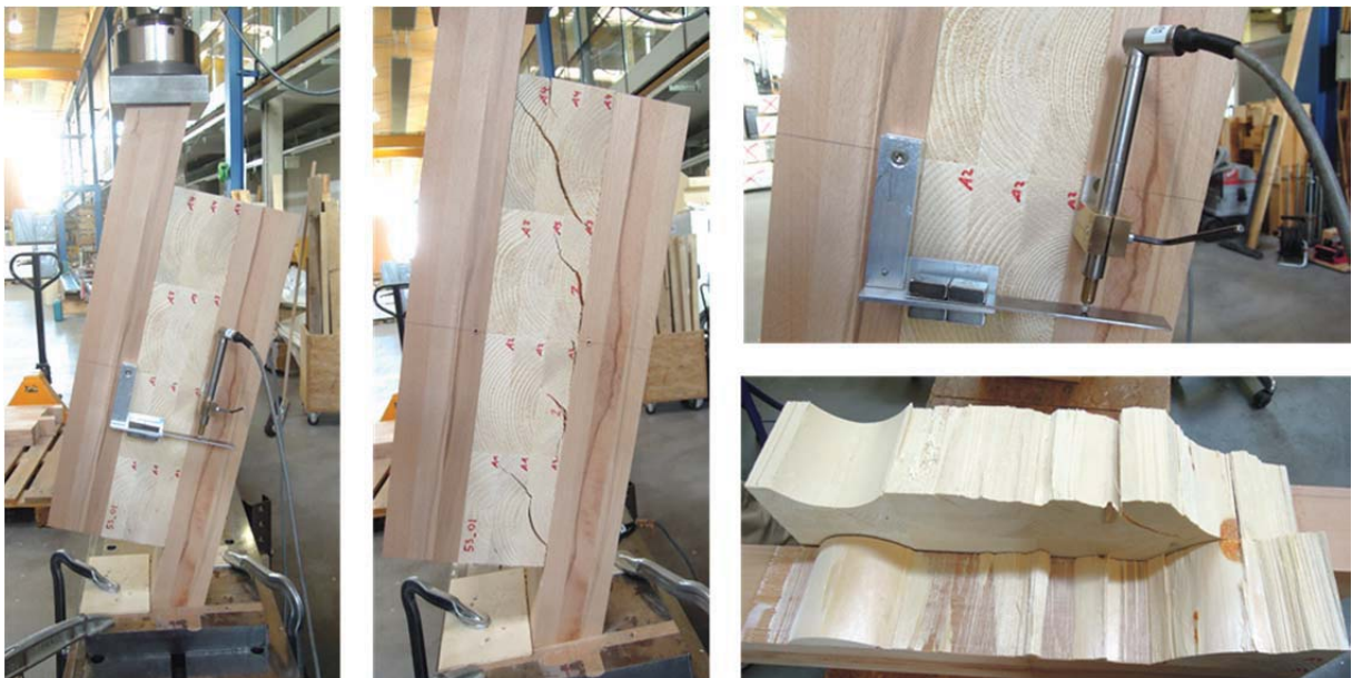
Abb. 3-34: Aufbau, Rissbildung und Versagen eines Prüfkörpers der Serie 5.3
