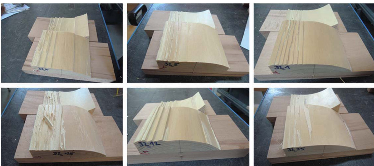
Abb. 3-25: Glatte Bruchfläche entlang der Jahrringe im Übergangsbereich von Früh- und Spätholz in Serie 3.2
