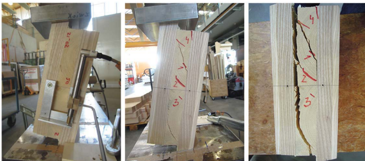
Abb. 3-30: Aufbau, Rissbildung und Versagen eines Prüfkörpers der Serie 5.1
