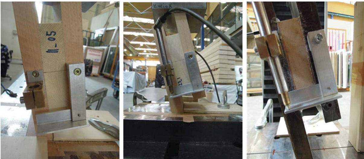
Abb. 2-8: Befestigung der Wegsensoren an Holz bzw. Stahllaschen
