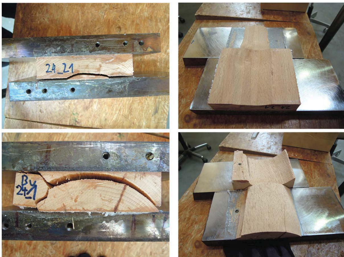
Abb. 3-17: Rollschubbruch entlang Jahrring bei Buchenprüfkörper
