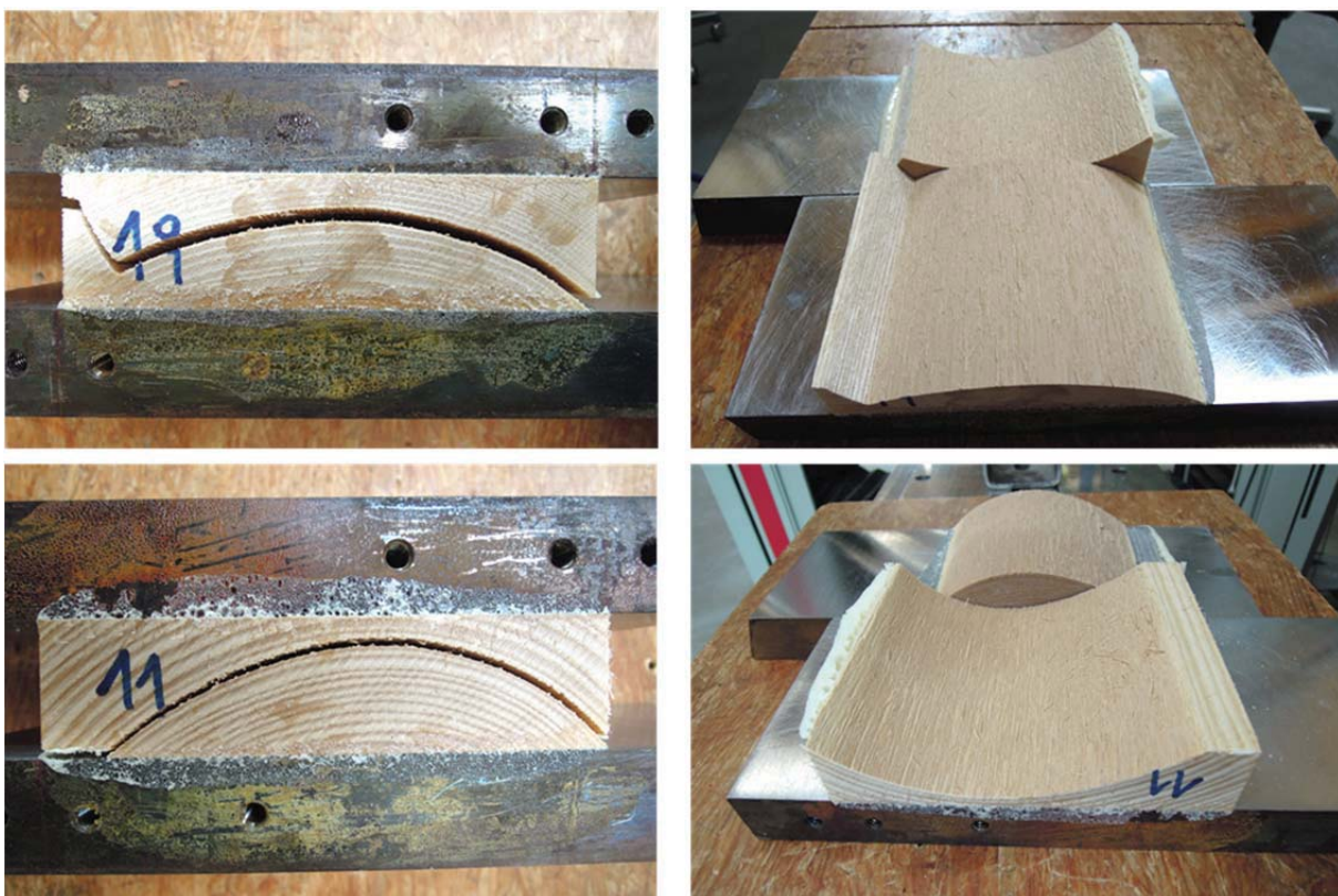
Abb. 3-13: Versagen von Esche-Prüfkörper entlang eines Jahrringes
