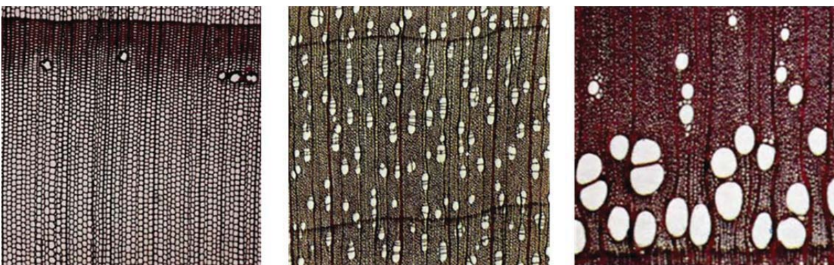
Abb. 1-4: Mikroquerschnitt von Fichte (Nadelholz, links), Birke (Zerstreutporer, mitte) und Esche (Ringporer, rechts) aus [5]; M = 1:15
