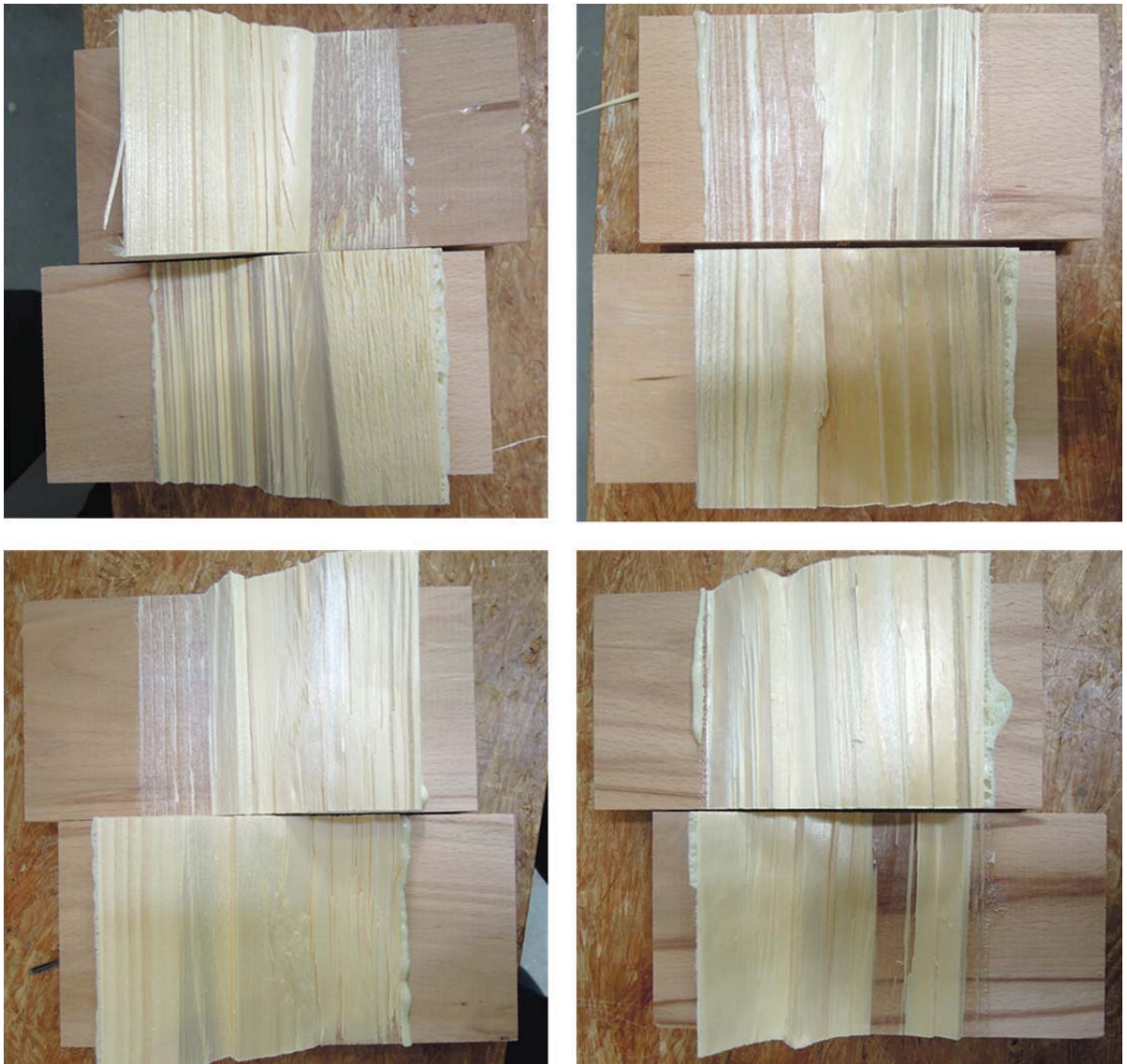
Abb. 3-9: Klebefläche nach Versagen mit ausreichenden Faserrückständen
