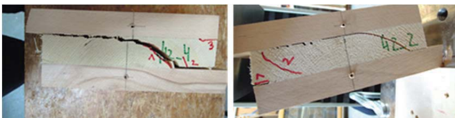
Abb. 3-29: Reines Rollschubversagen entlang der Jahrringe in Serie 4.2
