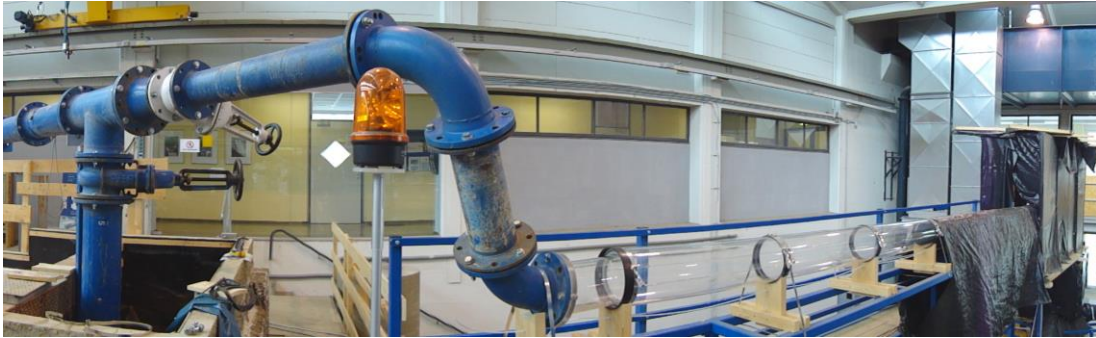
Abbildung 36: Zulaufleitung und Oberkammer des Modellversuchs Krespa
