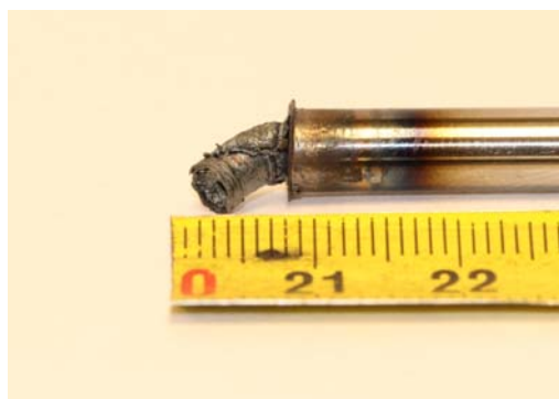
Abbildung 71: Verformung der biegeweichen Welle
