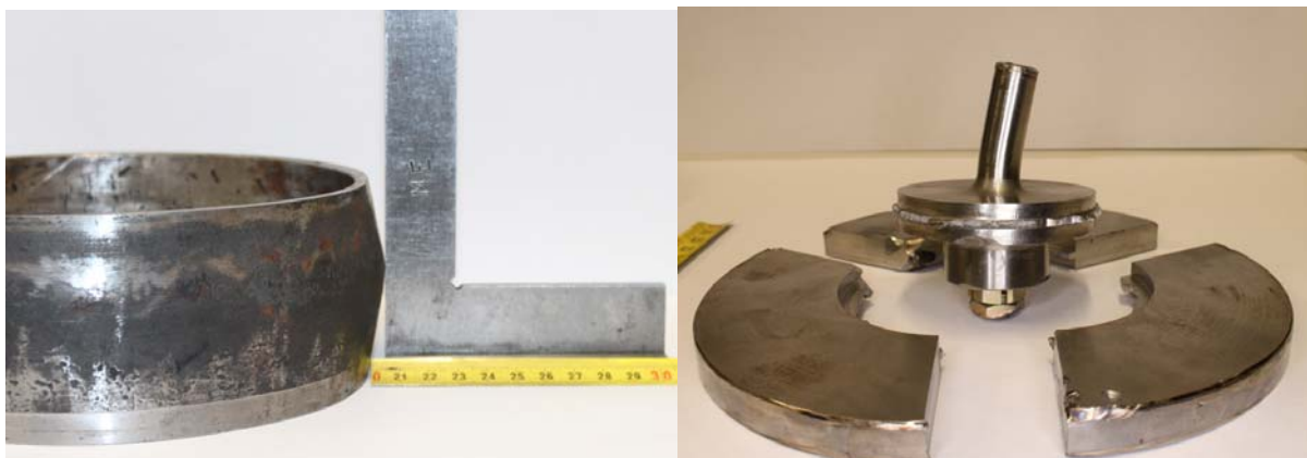
Abbildung 64: Bauteile nach dem Berstversuch (links Berstschuttring, rechts Versuchs-Flywheel)
