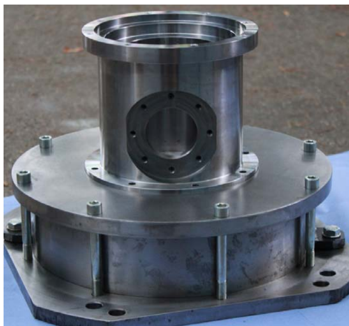
Abbildung 31: Gehäuse mit Ausfräsung für das Vakuumschauglas
