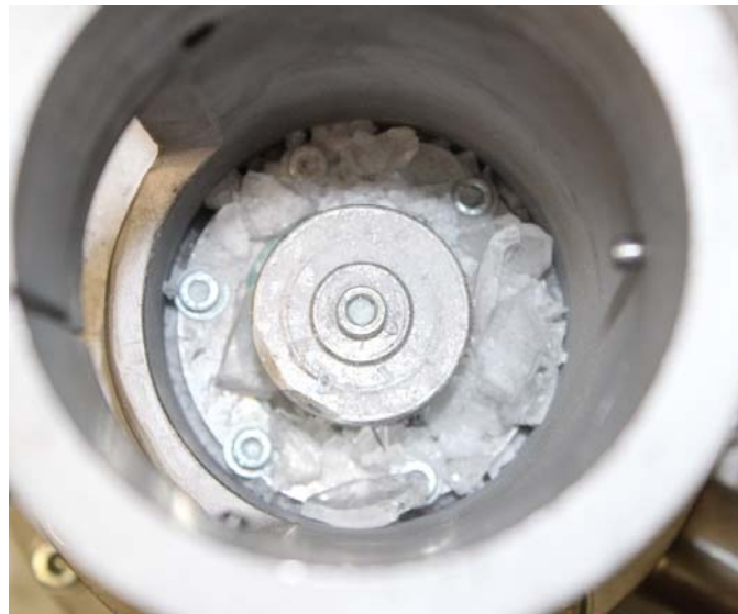
Abbildung 58: Schadensbild des Spalttopfes
