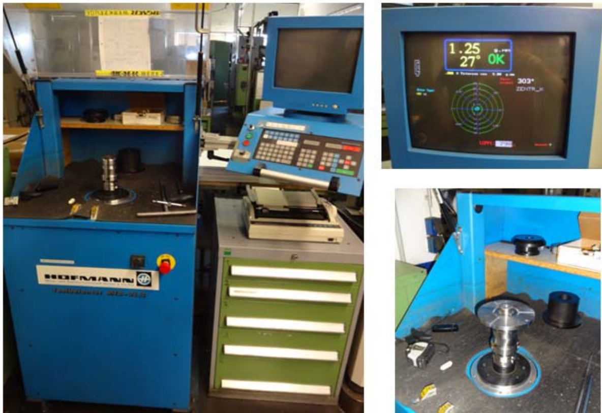
Abbildung 32: links Wuchtmaschine, rechts oben Anzeige der Unwucht, rechts unten eingespanntes Flywheel
