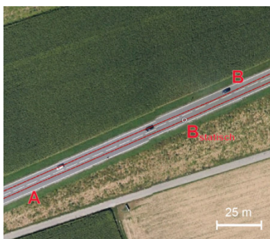
Abbildung 25: Zur Simulation des Geradenszenarios verwendete Segmente und Fahrzeuglage zum Kollisionszeitpunkt
