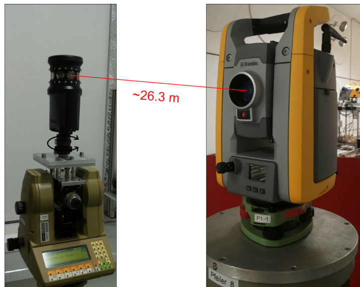
Abbildung 4.7: Die Leica TM1100 als Prismensträger und eine der zu untersuchenden Totalstationen
