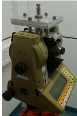
Abbildung 4.8: Die Leica TM1100 mit Adapterplatte und Steckzapfen
