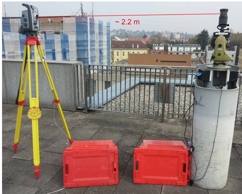
Abbildung 4.9: Die Totalstation Trimble S8 HP am Stativ und das Zielobjekt am Pfeiler.
