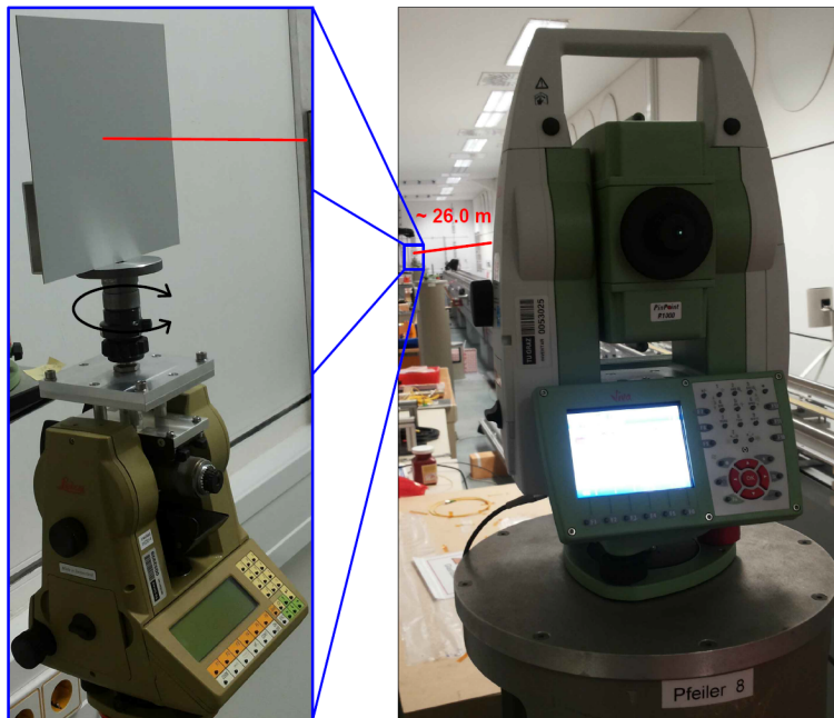
Abbildung 4.3: Adaptierte motorisierte Totalstation mit Zieltafel und die zu testende moderne Totalstation
