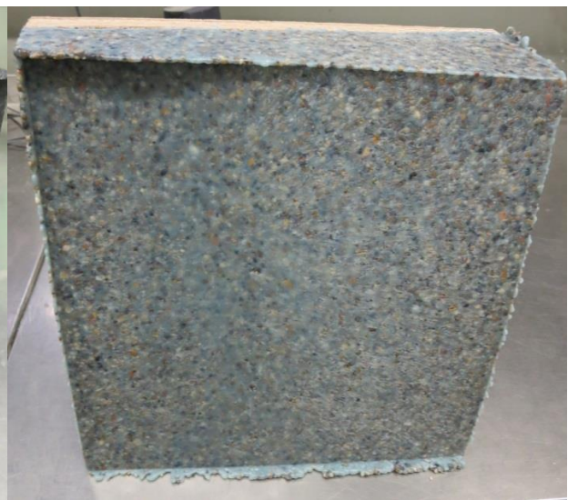
Abbildung 87 Wachsбетон schalung Rezeptur I
