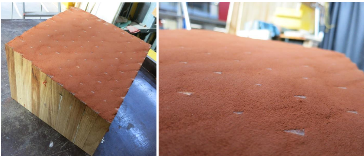
Abbildung 42 Verspachtelung mit O.B.B-Sand
