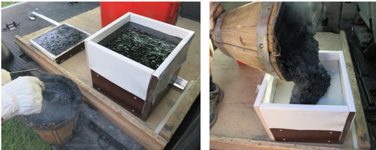
Abbildung 38 Abgießen mit Gussasphalt
