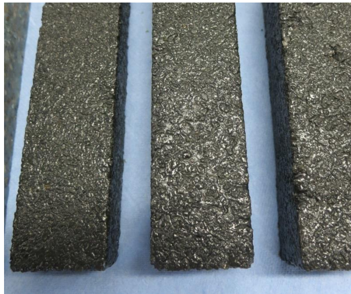
Abbildung 64 Unterseite (Stahlseite) Rezeptur III
