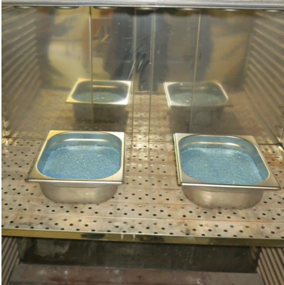
Abbildung 45 Wachs im Ofen aufschmelzen
