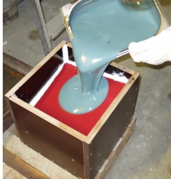
Abbildung 46 Ausgießen der Form
