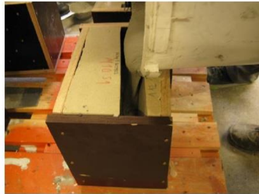
Abbildung 2: Befüllen einer Sand-Gussform (3-D Flächen-Schalung und Konterschaltung aus Sand)
