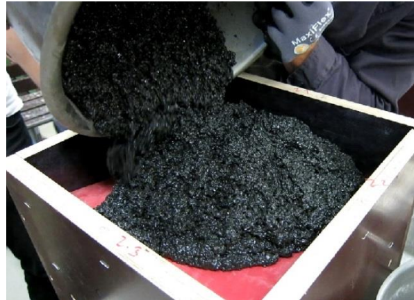
Abbildung 83 Gießvorgang mit Rezeptur III
