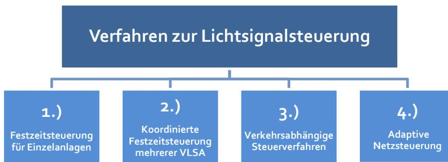
**Abbildung 8: Übersicht über Steuerverfahren von VLSA**
