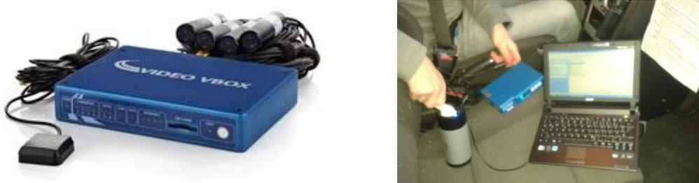
**Abbildung 60: Racelogic Video VBOX Pro (Racelogic, 2012) und Messaufbau (rechts)**
