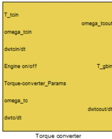
Abbildung 2.8: Drehmomentwandler in Simulink
