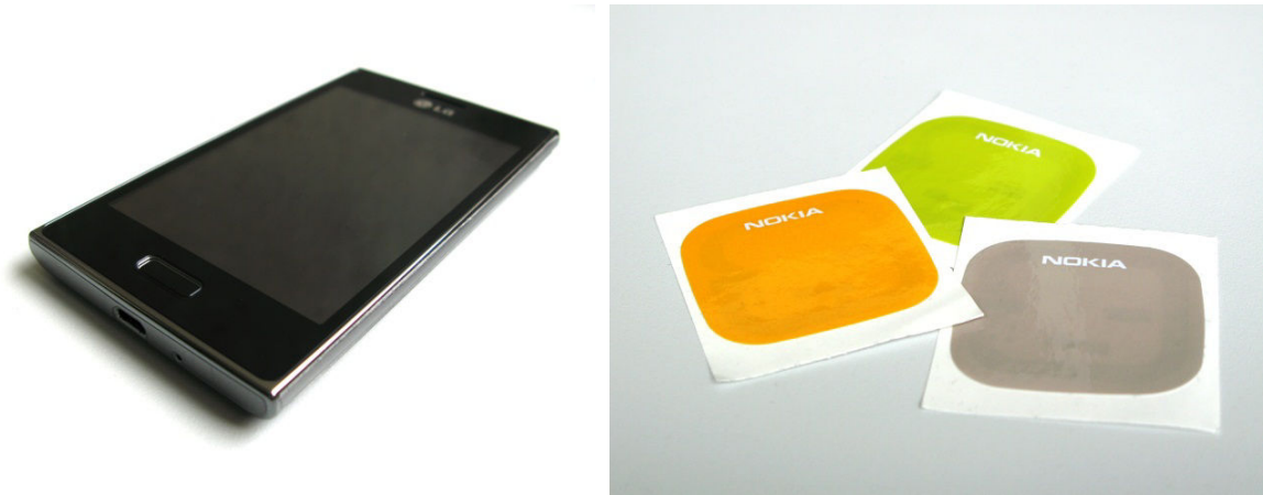
Abbildung 35: links: LG Mobiltelefon; rechts: RFID-Tags in Form von Klebeetiketten
