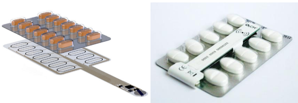
Abbildung 13: OTCM™-System; links: Blisteraufbau [49]; rechts: fertig bestückter Blister mit Mikroprozessor und NFC-Modul
