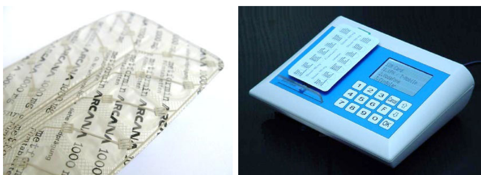
Abbildung 14: OTCM™-System; links: Leiterbahnen auf Blisterfolie; rechts: DataTaker™ mit Blister zur Datenübertragung [49]
