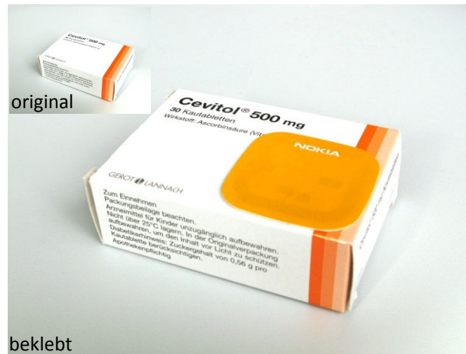
Abbildung 36: Arzneimittel mit und ohne angebrachten RFID-Tag
