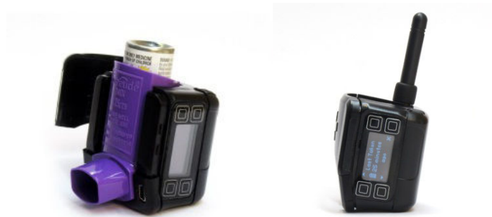
Abbildung 24: Smartinhaler™ [58]; links: mit USB-Schnittstelle; rechts: mit GSM-Übertragung
