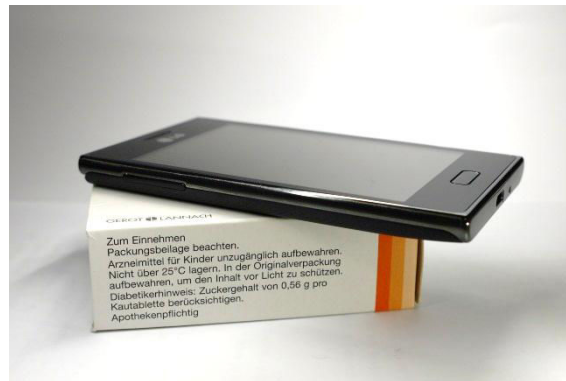
Abbildung 45: Auslesen des RFID-Tags mittels Mobiltelefon
