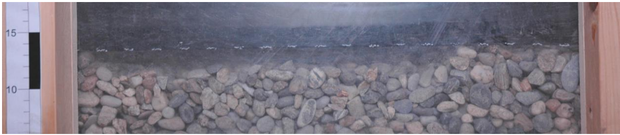
Abbildung 60: Vorspanngraben vor Aufschüttung, Versuch 1, 0.5 % Dehnung
