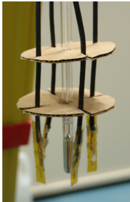
Abbildung D-3: Positionierung der Sensoren und des Thermometers mit Kartonscheiben
