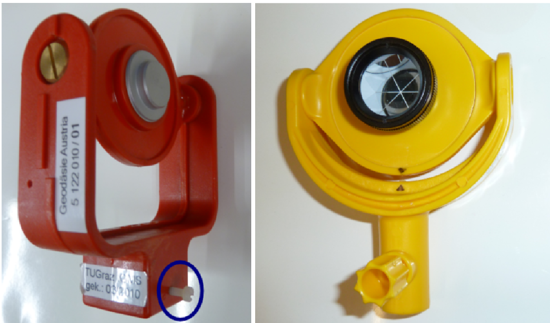
Abbildung A-18: zusätzliche Klemmschraube Miniprisma Geodäsie Austria (links), im Vergleich die serienmäßige Schraubverriegelung am Miniprisma Goecke (rechts)
