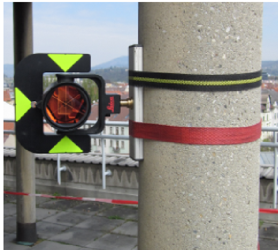
Abbildung 8-7: Prisma für Referenzstrecke mit Item Profil und Spanngurten montiert
