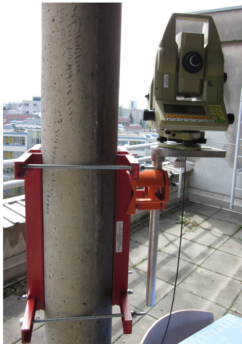
Abbildung 8-1: TCA 1800 mit Klemmstativ auf Säule montiert
