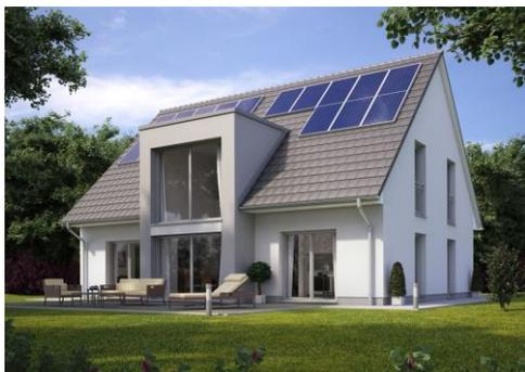
Abbildung 29: Dachintegrierte PV-Anlage
