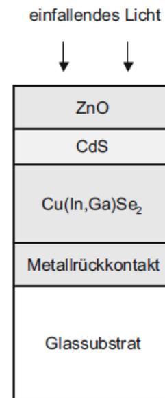
Abbildung 15: Aufbau einer CIS/CIGS Solarzelle [11]
