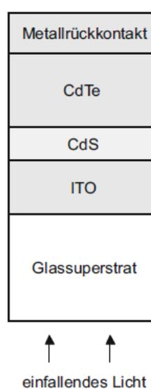
Abbildung 14: Aufbau einer CdS/CdTe-Zellstruktur [11]
