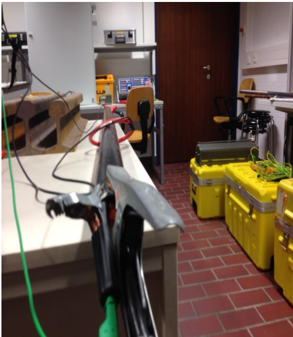
Abbildung 5-5 Einspeisung über Omicron CPC 100 an den Enden der Rohrleitung
