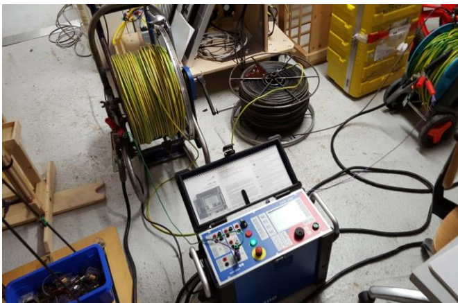
Abbildung 6-12 Bestimmung von R Begleitkabel
