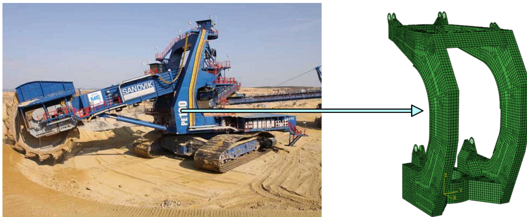
Abbildung 1.1: Beispiel eines Schaufelradbaggers und dessen Dreheinrichtung als FEM-Modell
