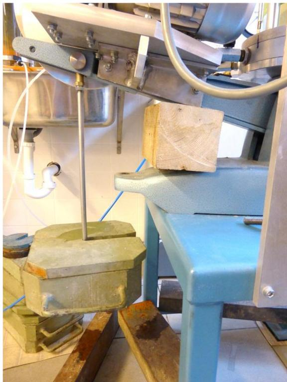
Abb. 55 Stellschraube ersetzt durch Holzklötz
