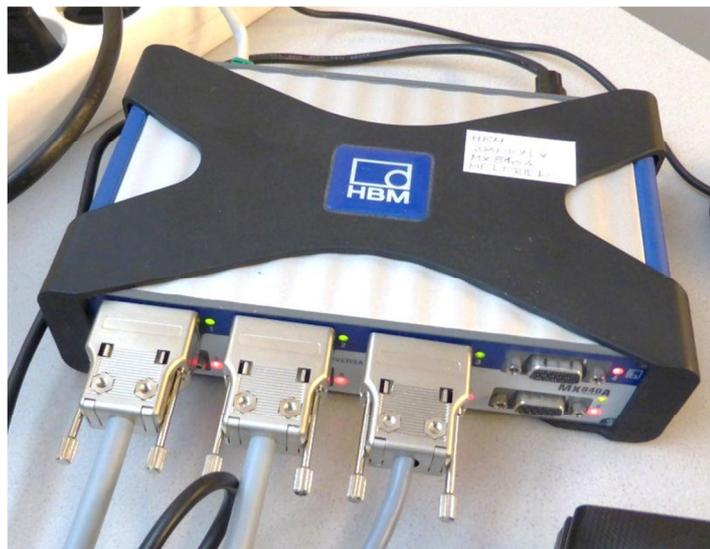
Abb. 12 Messkraftverstärker Quantum MX 840 A
