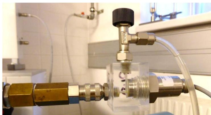
Abb. 18 Porenwasserdruckmessgeber
