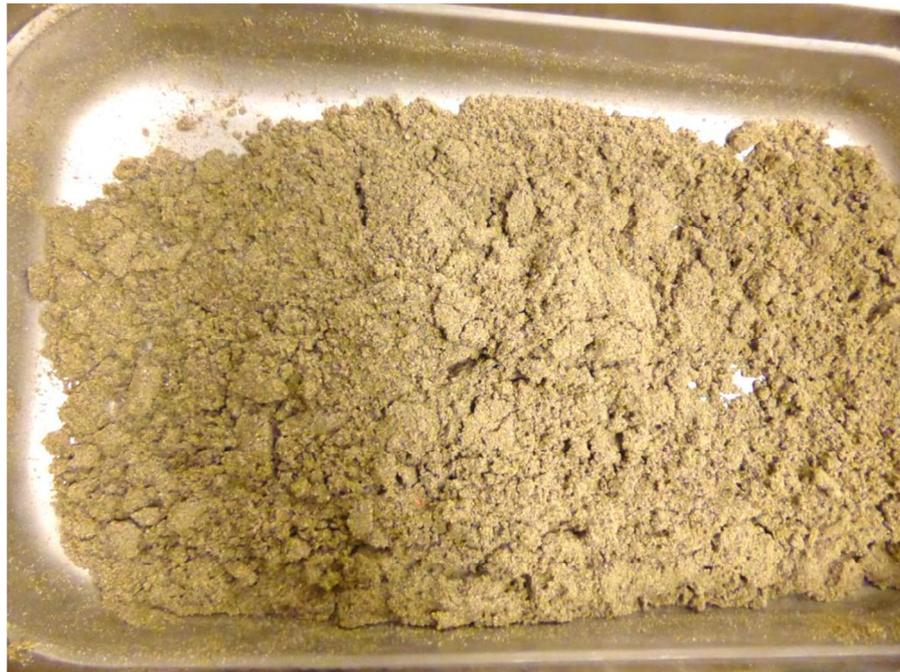
Abb. 41 Versuchssand mit 15% Wassergehalt
