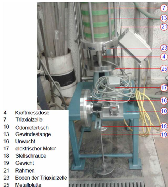
Abb. 3 Dynamischer Triaxial Versuchsaufbau – alt, vorne
