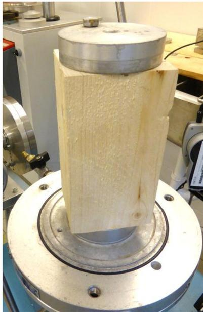
Abb. 22 Prüfkörper aus Holz
