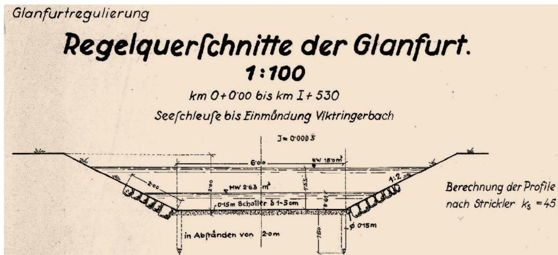
Abbildung 5: Regelquerschnitt aus Glanfurtregulierung 1956<sup>6</sup>
