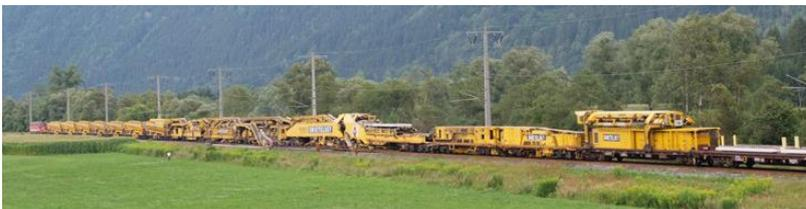
Abbildung 15<sup>73</sup> und Abbildung 16<sup>74</sup>: Kombinierte Gleisumbau- und Schotterbettreinigungsmaschine RU 800 S
