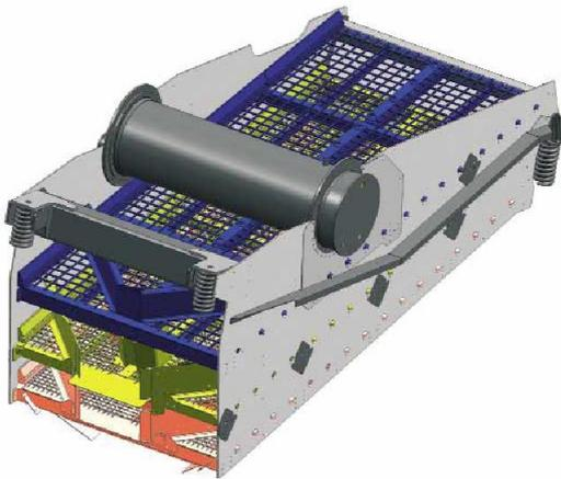
Abbildung 10: Schematische Darstellung einer Siebanlage mit 3 Siebdecks<sup>46</sup>
