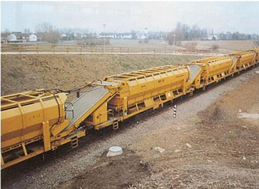
**Abbildung 13: Mehrere aneinander gekoppelte Materialförder- und Siloeinheiten<sup>59</sup>**
