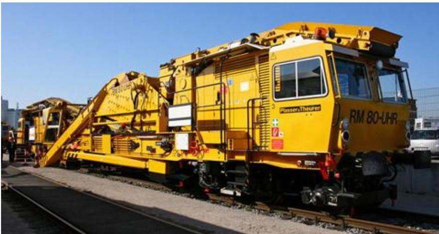
Abbildung 14: Schotterbettreinigungsmaschine RM 80 UHR<sup>69</sup>
