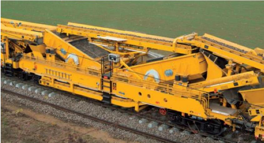
Abbildung 11: Doppelsiebanlage einer RU 800 S<sup>47</sup>
