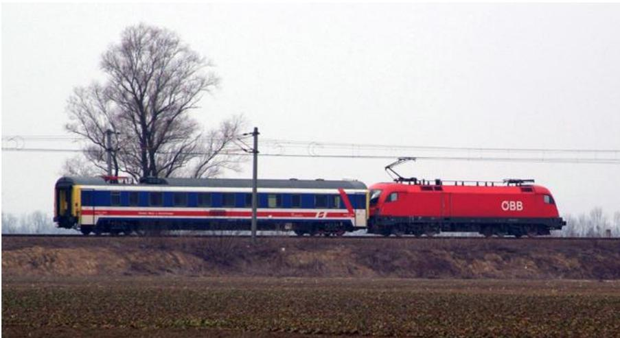
Abbildung 4: Messwagen der ÖBB mit dem die Daten für die Beschreibung der Gleislagequalität gewonnen werden<sup>13</sup>
