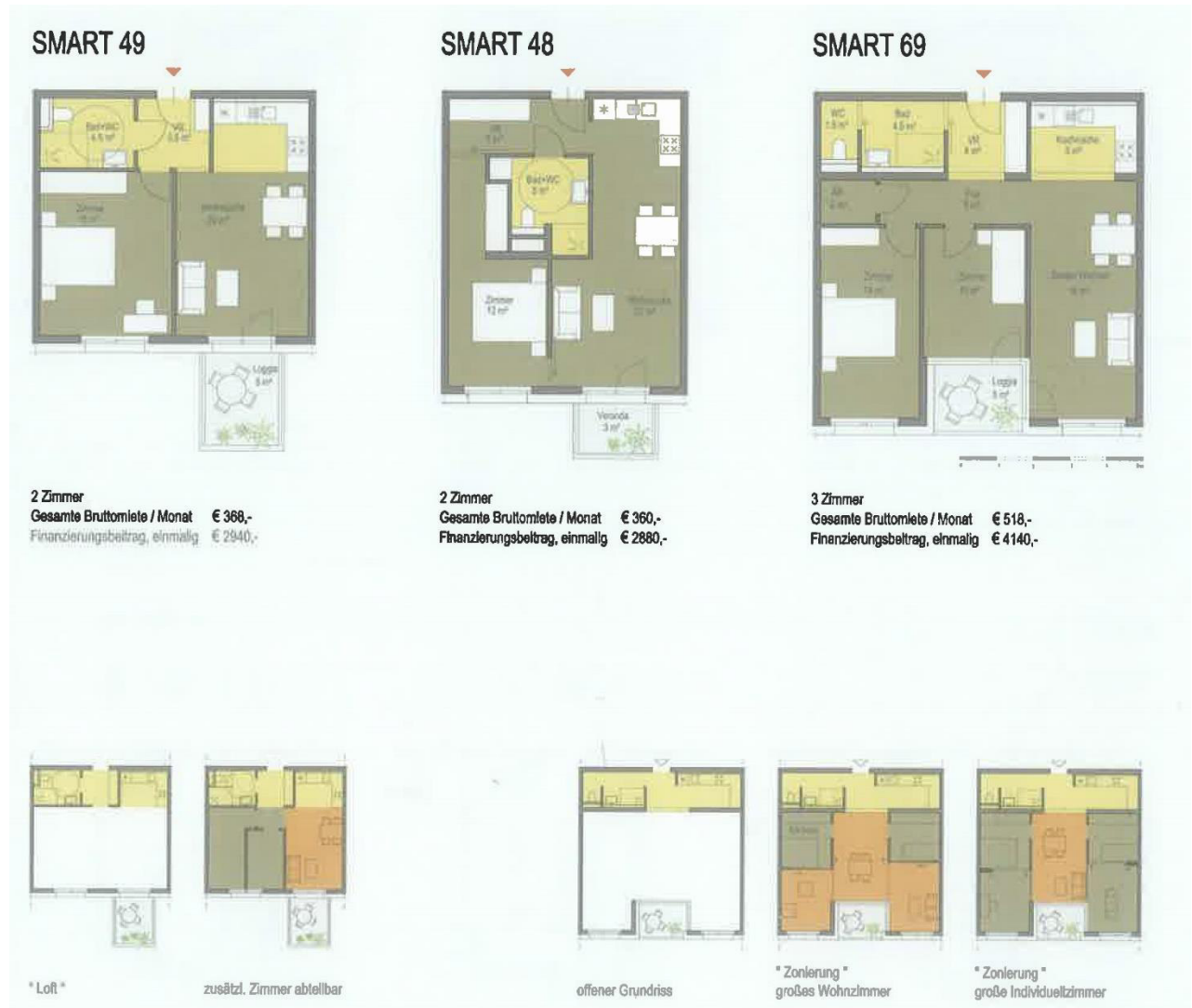
Abb. 5 Sonnwendviertel 2 Bauplatz C.04, Grundrissvarianten
