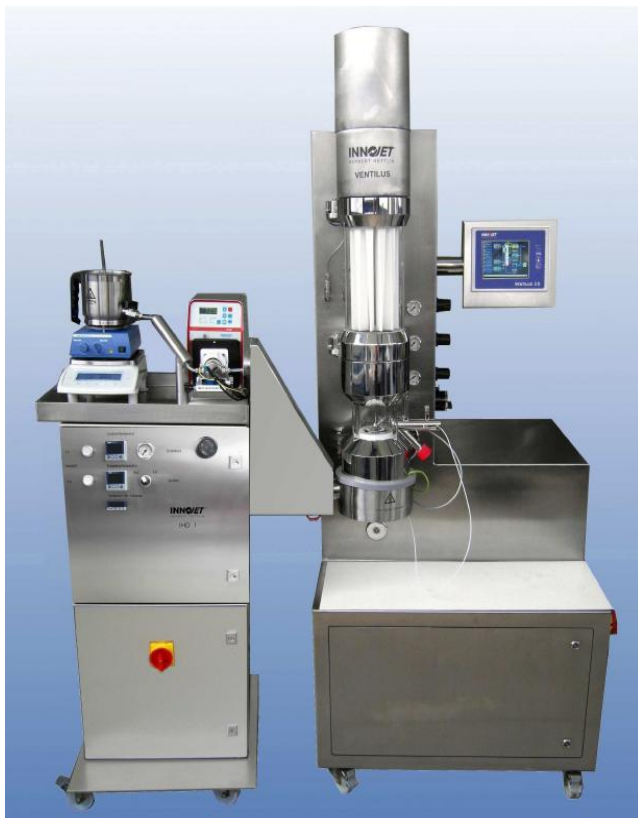
Fig. 3.3. INNOJET® Hot Melt Device (IHD1) (INNOJET® Herbert Hüttlin 2012b)
