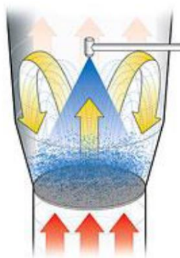
Fig. 1.5. Top spray coating (Glatt GmbH 2014)
