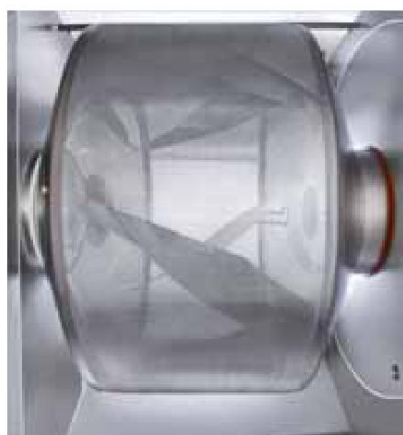
Fig. 1.4. Drum coater (Glatt GmbH 2011)
