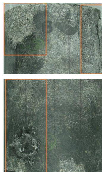
Abbildung 4.21: Bruch in der Nähe von Sensoren 3/ 1 (oben) und Sensor 4 (unten)
