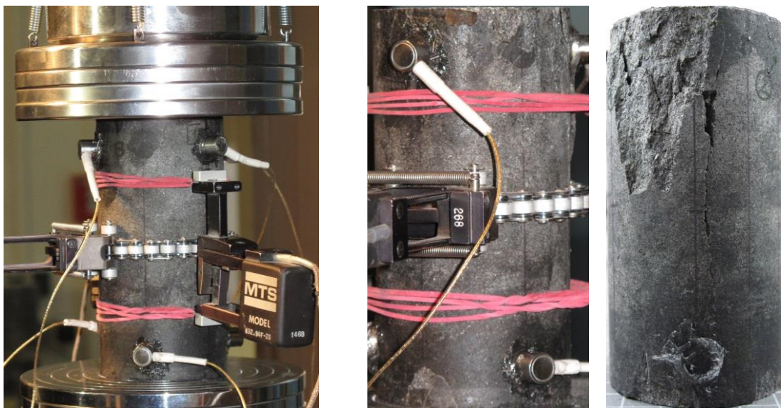
Abbildung 4.15: eingebaute Gesteinsprobe in der Prüfmaschine (links); zerstörte Gesteinsprobe nach dem einaxialen Druckversuch (rechts)
