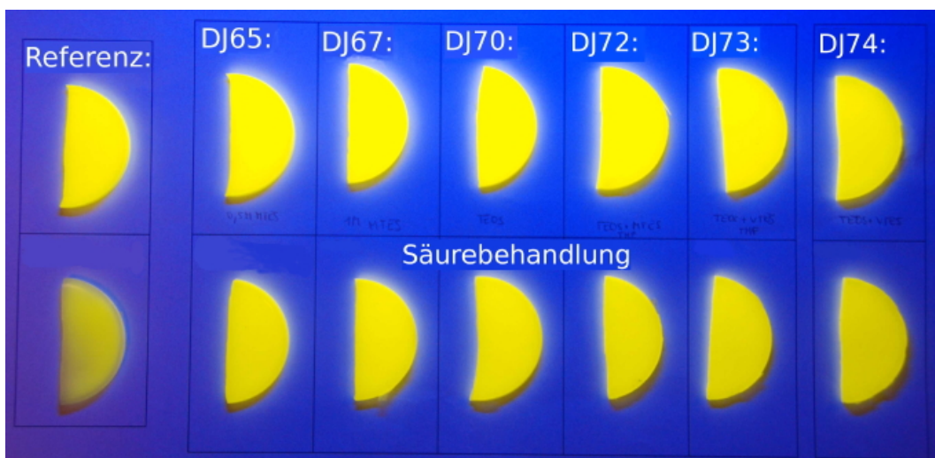
Abbildung 3.20: Ein Vergleich der unterschiedlichen Alkyl-Silikaschichten mittels MTES und VTES nach dem Säuretest. Auch die unterschiedlichen Konzentrationen an MTES können verglichen werden. Weiters auch der Einsatz von THF als Lösungsmittel. Referenz: unbeschichteter Phosphor, DJ65: 0,5 M MTES; DJ67: 1 M MTES; DJ70: TEOS; DJ72: TEOS+MTES in THF; DJ73: TEOS+VTES in THF; DJ74: TEOS+VTES; Die obere Reihe dient als unbeschichtete Referenz, die untere Reihe zeigt die Auswirkung der Säurebehandlung, den Verlust der Leuchtkraft.
