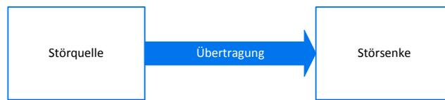
Abb. 2.1: Elektromagnetisches Umfeld im Kraftfahrzeug
