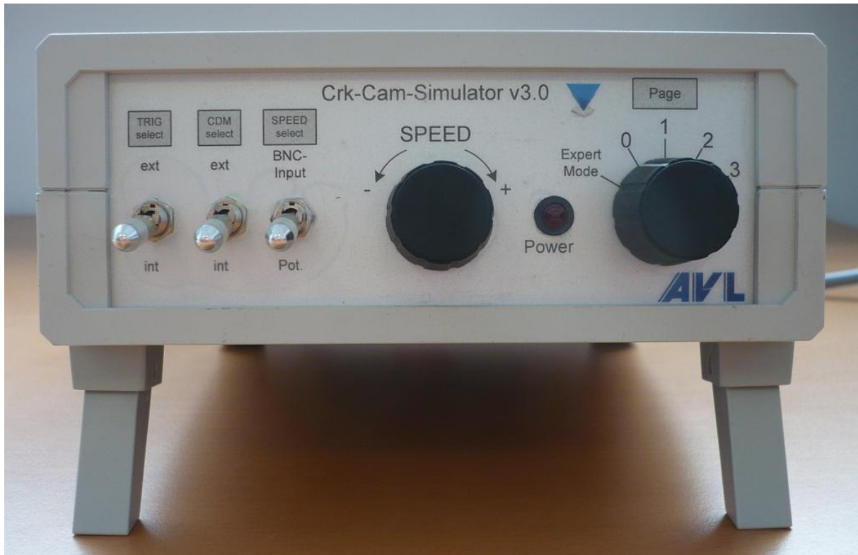
Abbildung 5.2 Signalgenerator für Kurbel- und Nockenwellensignale
