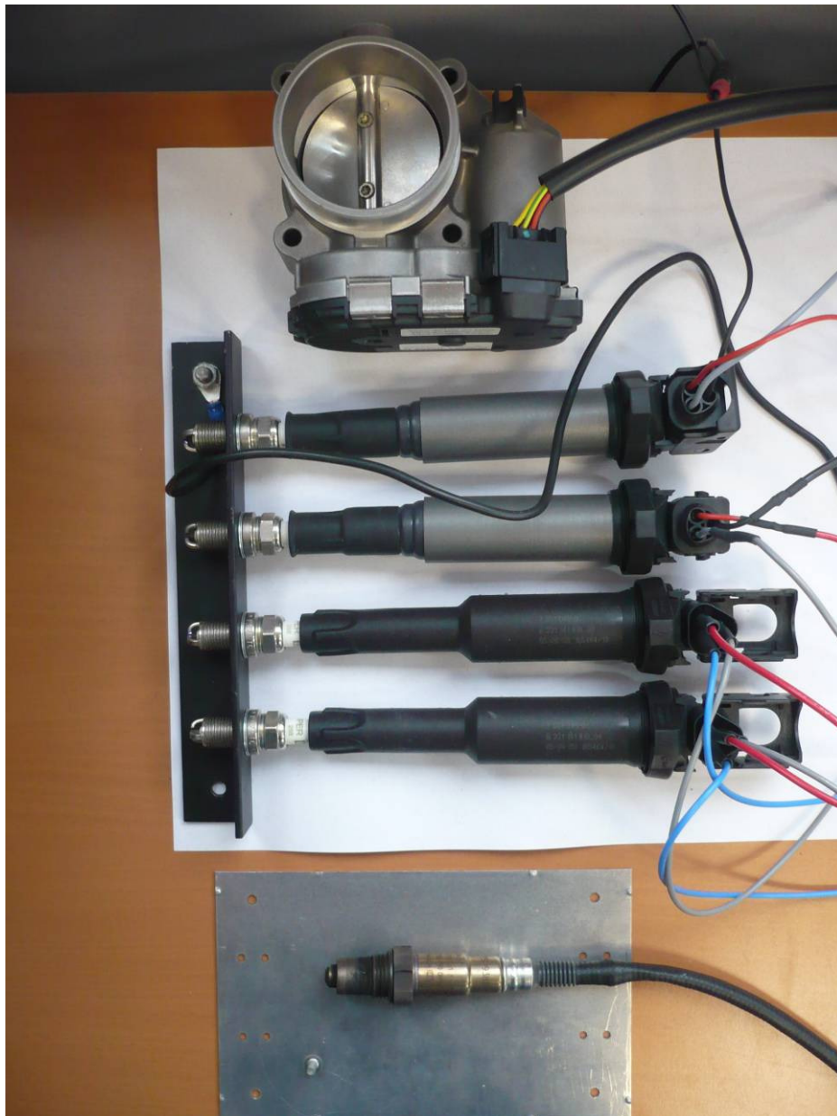
Abbildung 5.8 Versuchsaufbau im Labor (Drosselklappe, Zündspulen und Lambdasonde)
