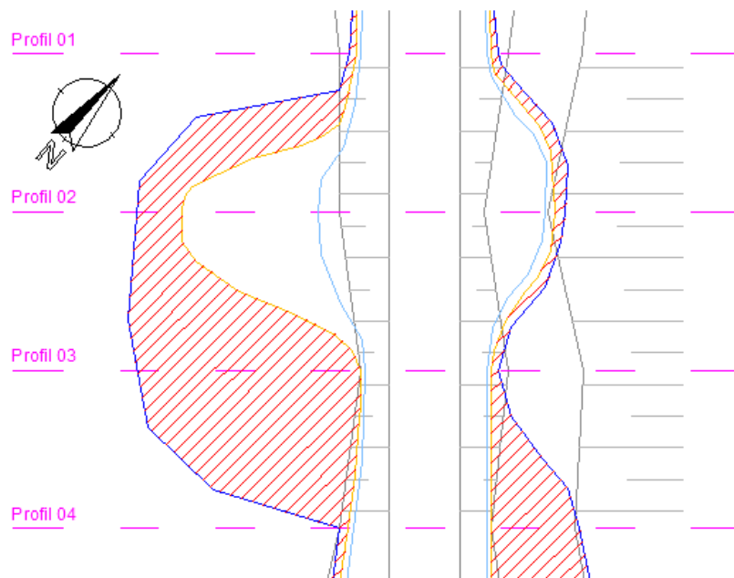
Abb. 71: Subtraktion der Überflutungsflächen zwischen 00:15 und 00:30
