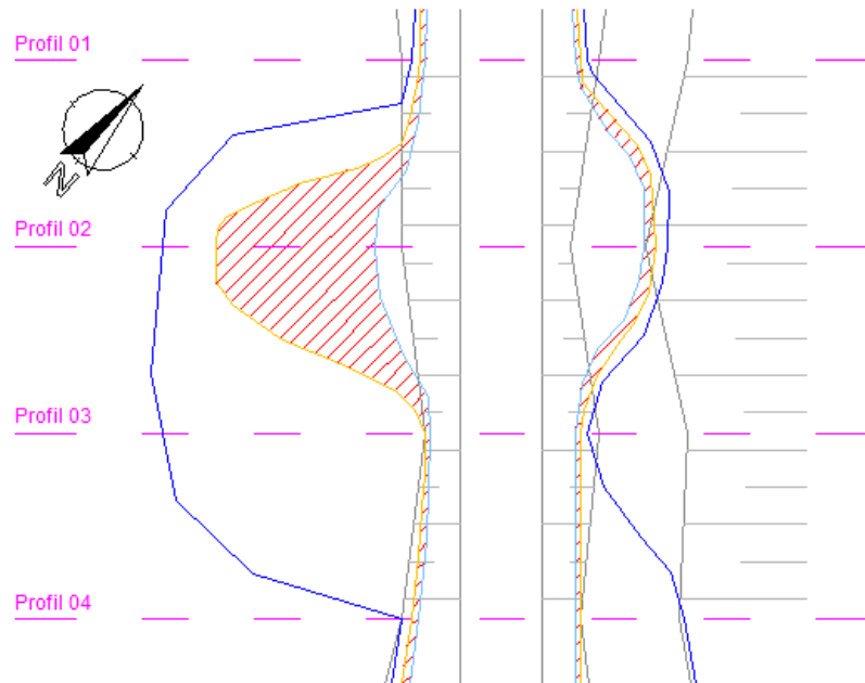
Abb. 70: Subtraktion der Überflutungsflächen zwischen 00:00 und 00:15
