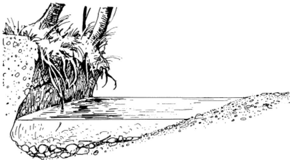
Abb. 65: Ausbildung von Prall- und Gleitufer [72]
