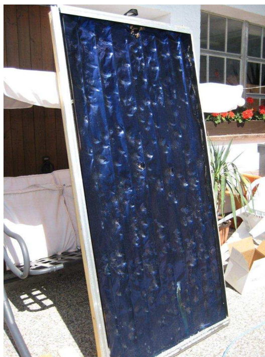
Abbildung 35: Hagelschaden durch TORRO 6 Solarpaneel
