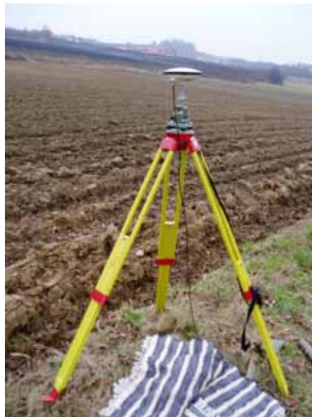
Abbildung 4.6: Feldarbeiten: Passpunktmessung zur Bestimmung von Transformationsparametern (KT 122-166)
