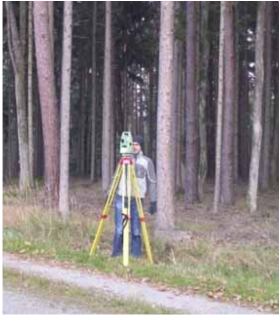
Abbildung 4.14: Feldarbeit: Einmessen von Probekreisen
