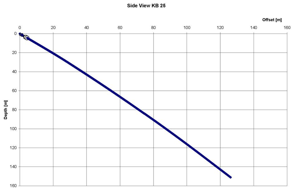
Abb. 24: Seitenansicht der Kernbohrung KB 25
