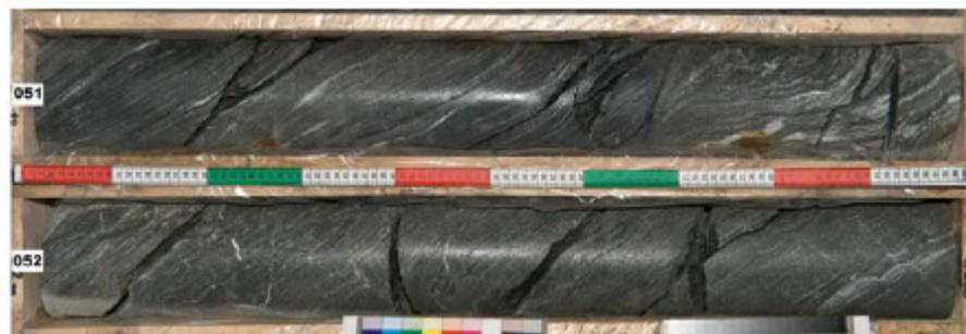
Abb. 34: Albitphyllit, Wechselschiefer nahe Wechselgneis, KB 24 in 51-52 m Tiefe
