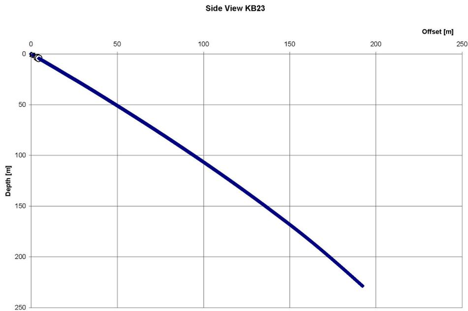
Abb. 20 Seitenansicht der Kernbohrung KB 23
